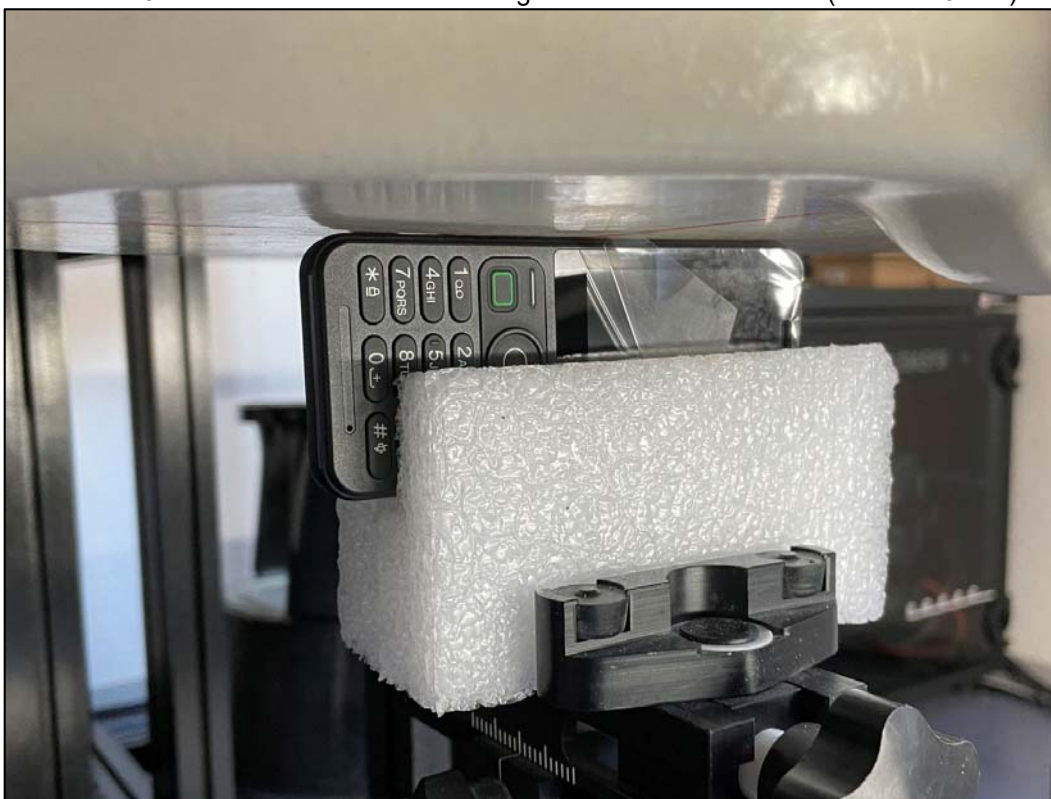
Photo 11: Position d'essai face du côté droite contre le membre (distance 0 mm)
