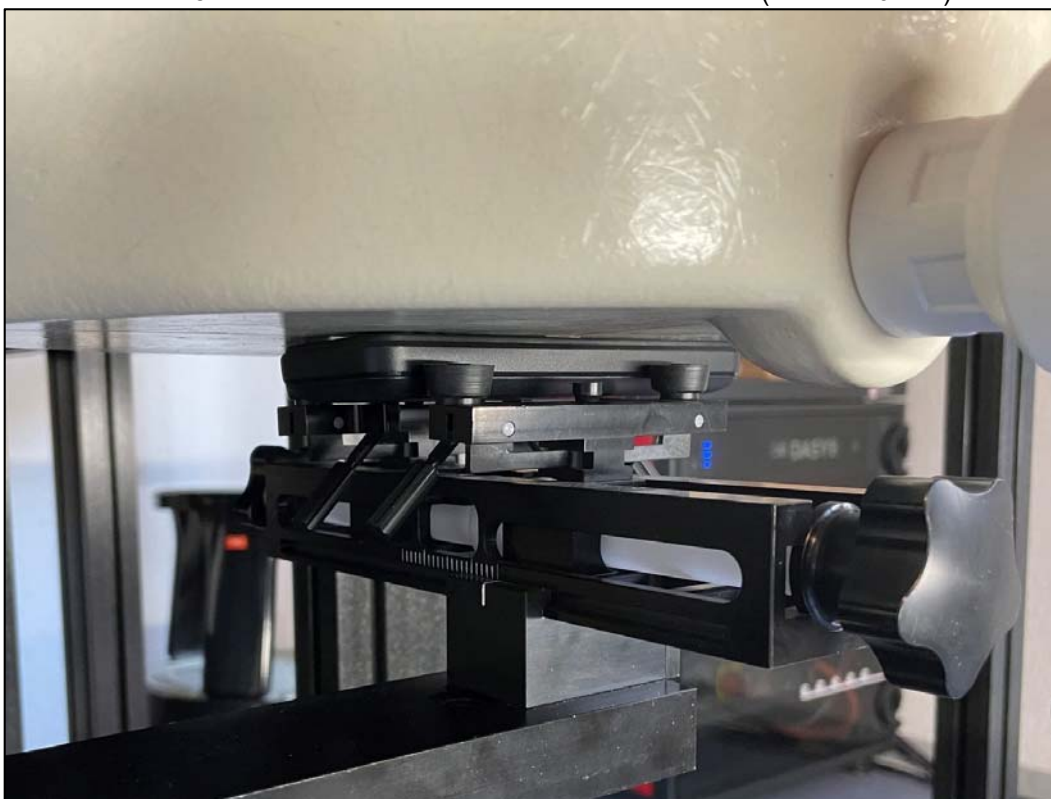
Photo 9: Position d'essai face arrière contre le membre (distance 0 mm)
