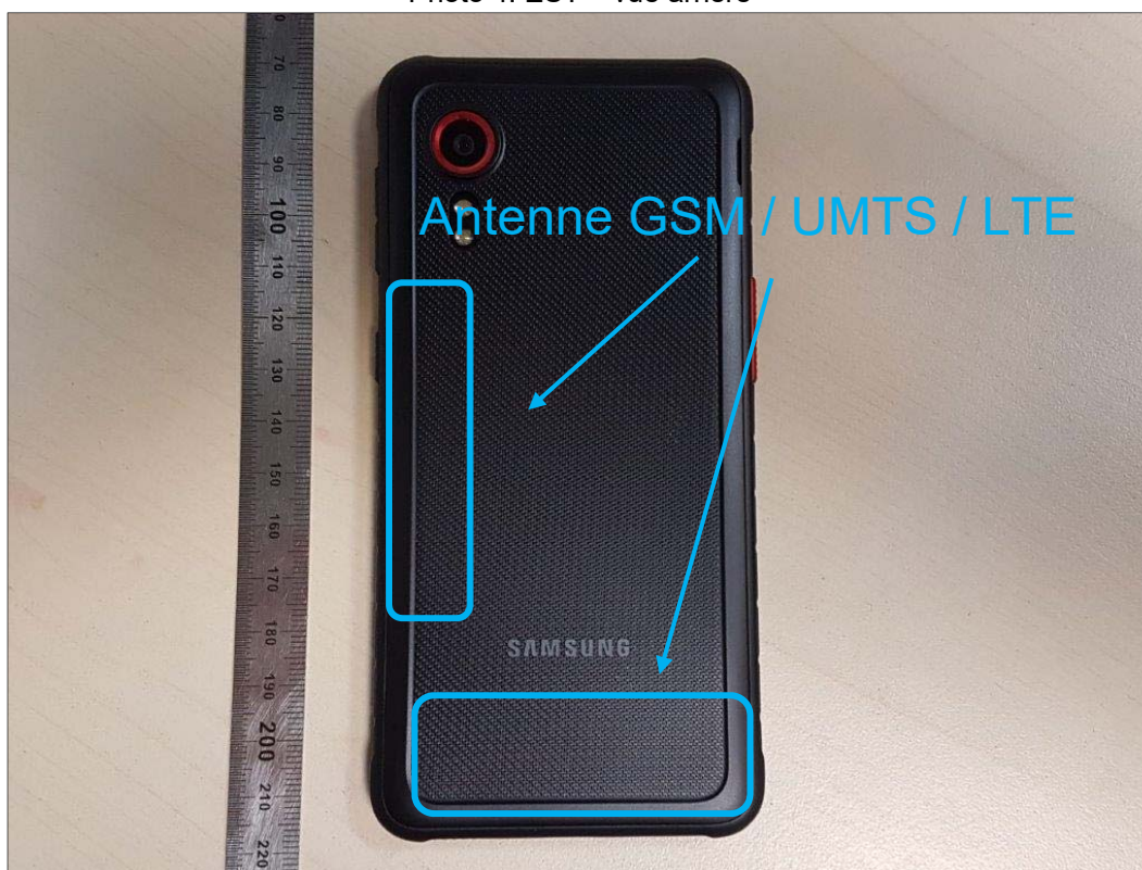
Photo 4: EST – vue arrière
