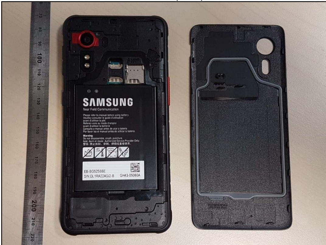
Photo 6: EST – vue arrière (ouvert) sans batterie
