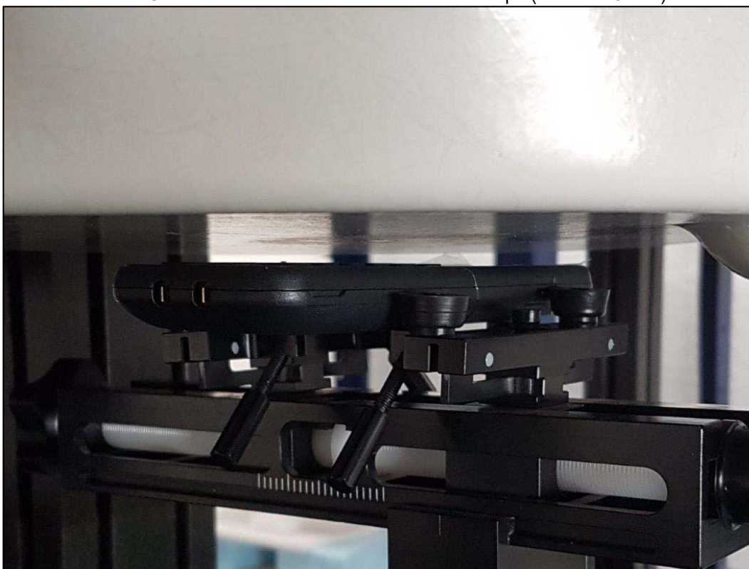
Photo 9: Position d'essai face arrière contre le corps (distance 5 mm)
