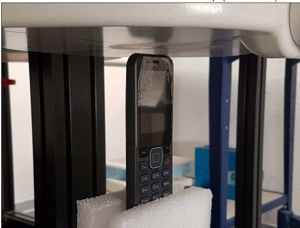
Photo 13: Position d'essai face du dessous contre le corps (distance 5 mm)
