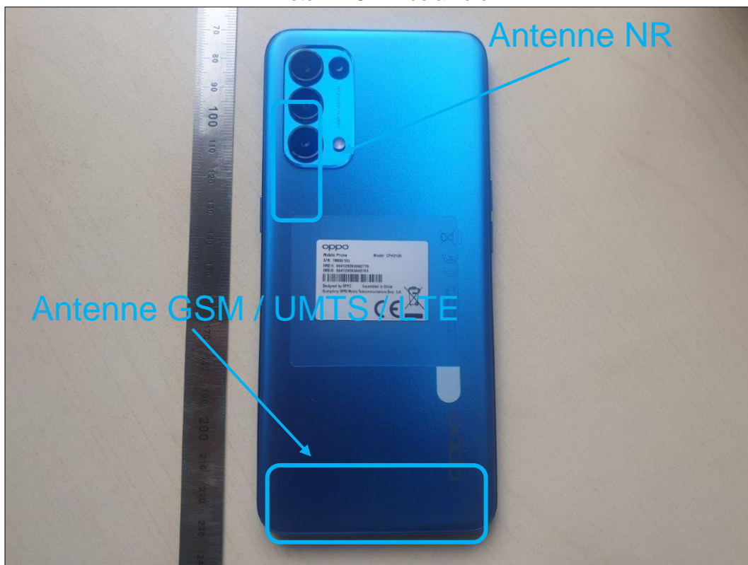
Photo 4: EST – vue arrière
