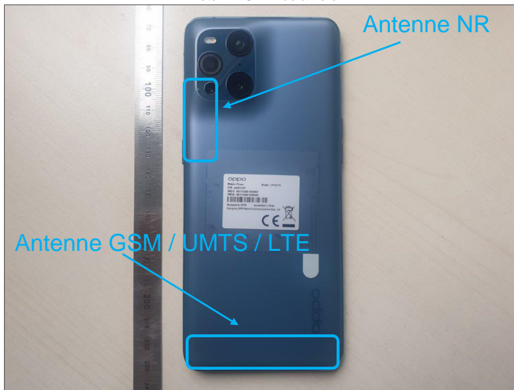
Photo 4: EST – vue arrière
