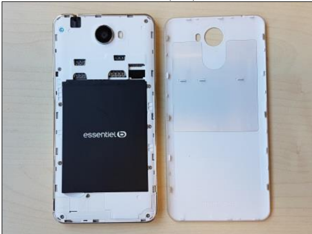
Photo 5: EST – vue arrière (ouvert) avec batterie
