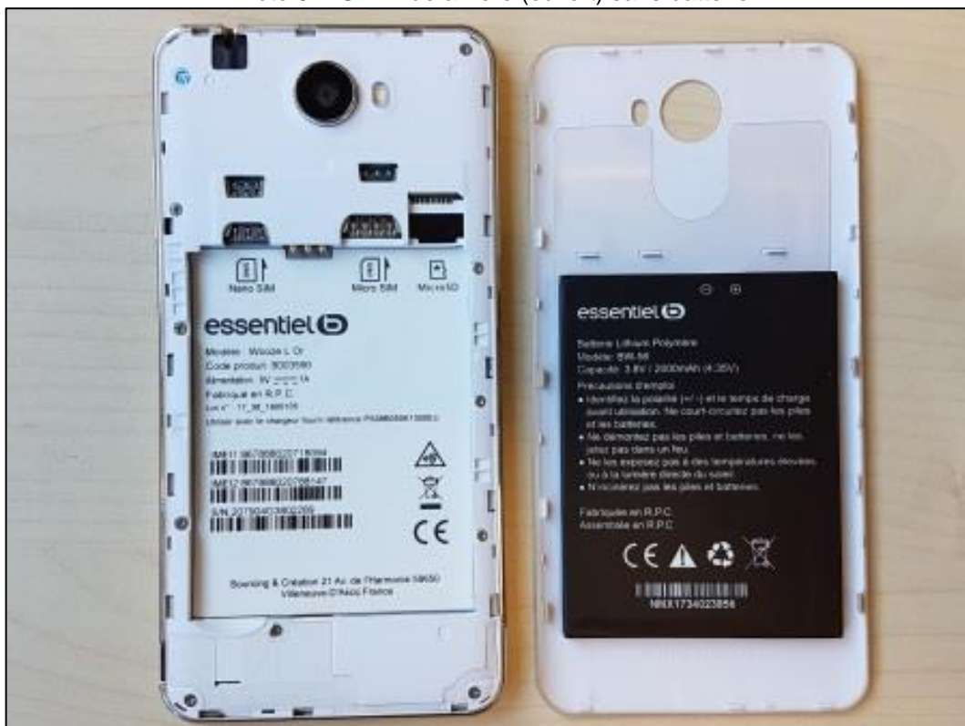
Photo 6: EST – vue arrière (ouvert) sans batterie
