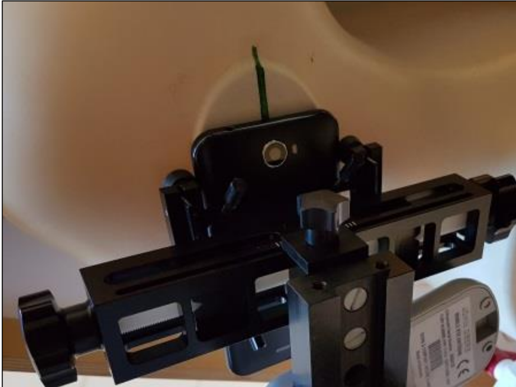
Photo 11: Position d'essai main gauche, contre la joue
