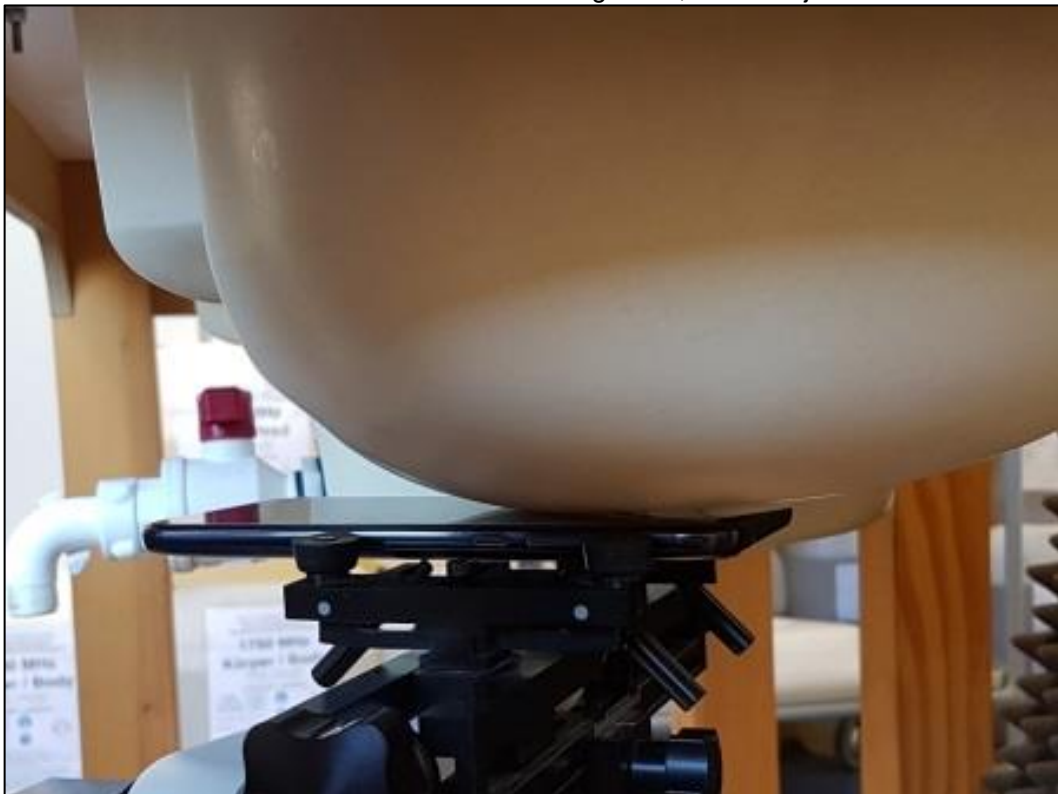
Photo 10: Position d'essai main gauche, contre la joue
