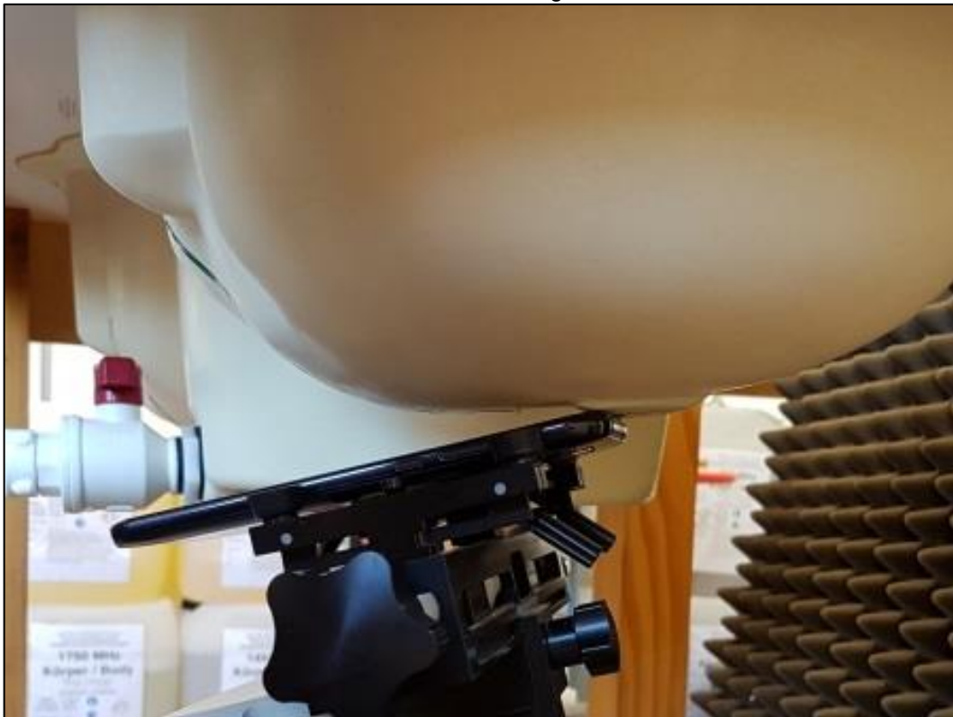
Photo 13: Position d'essai main gauche, incliné 15°
