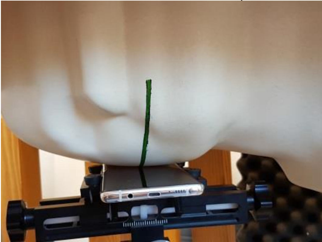
Photo 12: Position d'essai main droite, contre la joue
