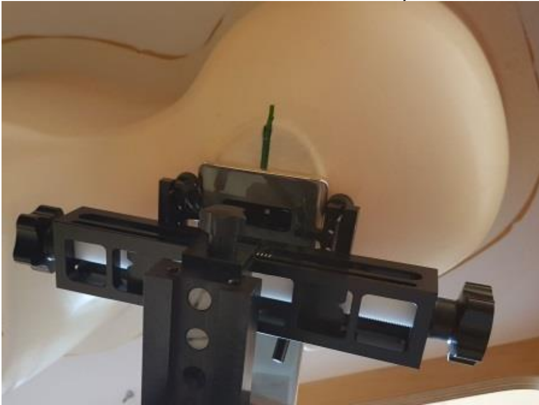
Photo 14: Position d'essai main droite, incliné 15°
