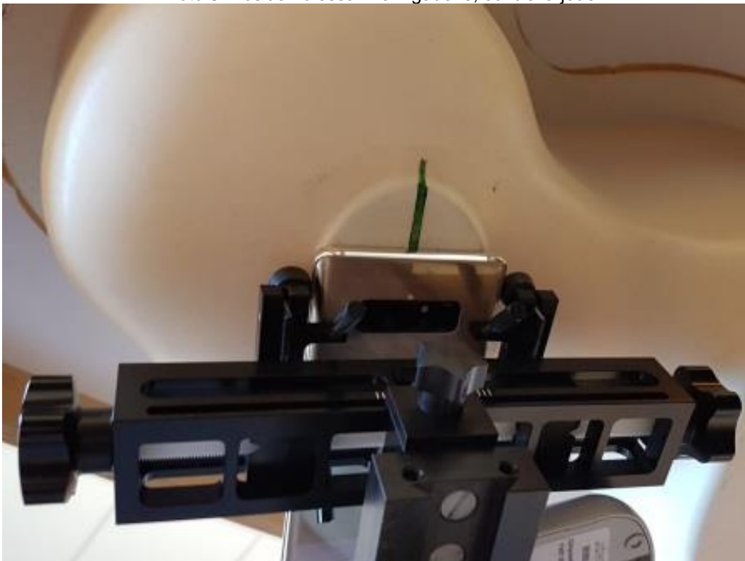
Photo 8: Position d'essai main gauche, contre la joue
