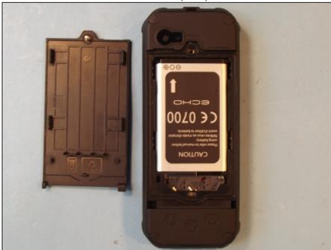
Photo 5: EST – vue arrière (ouvert) avec batterie
