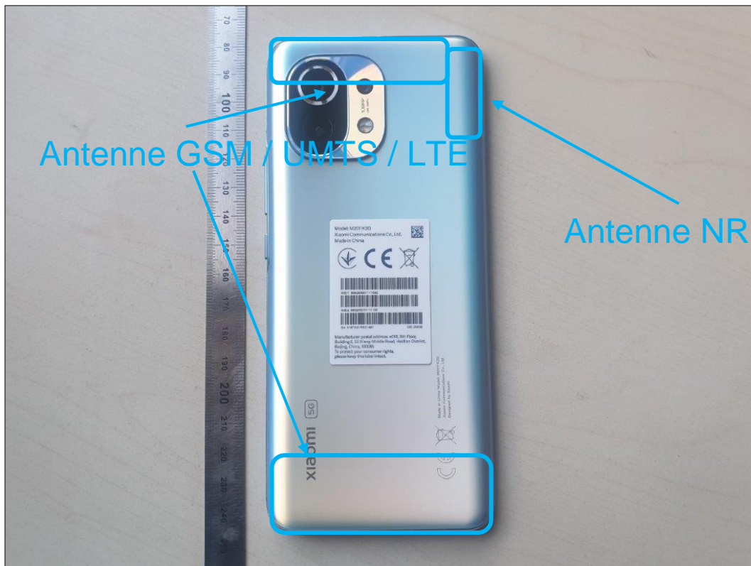
Photo 4: EST – vue arrière
