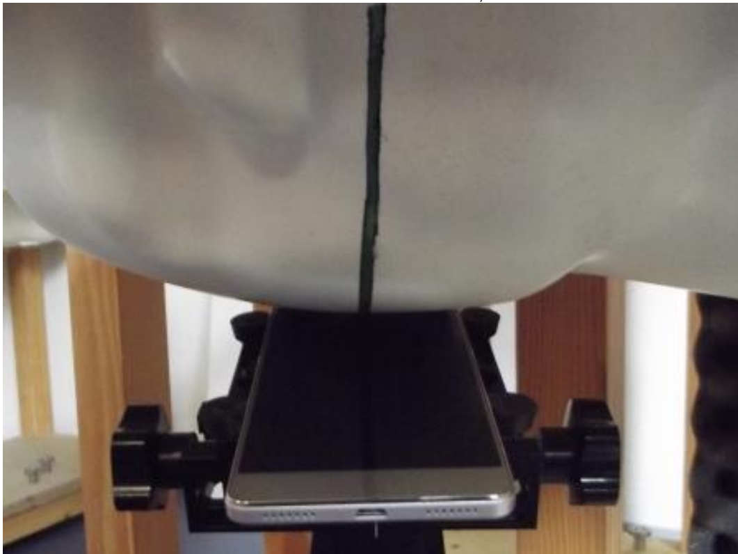
Photo 14: Position d'essai main droite, incliné 15°
