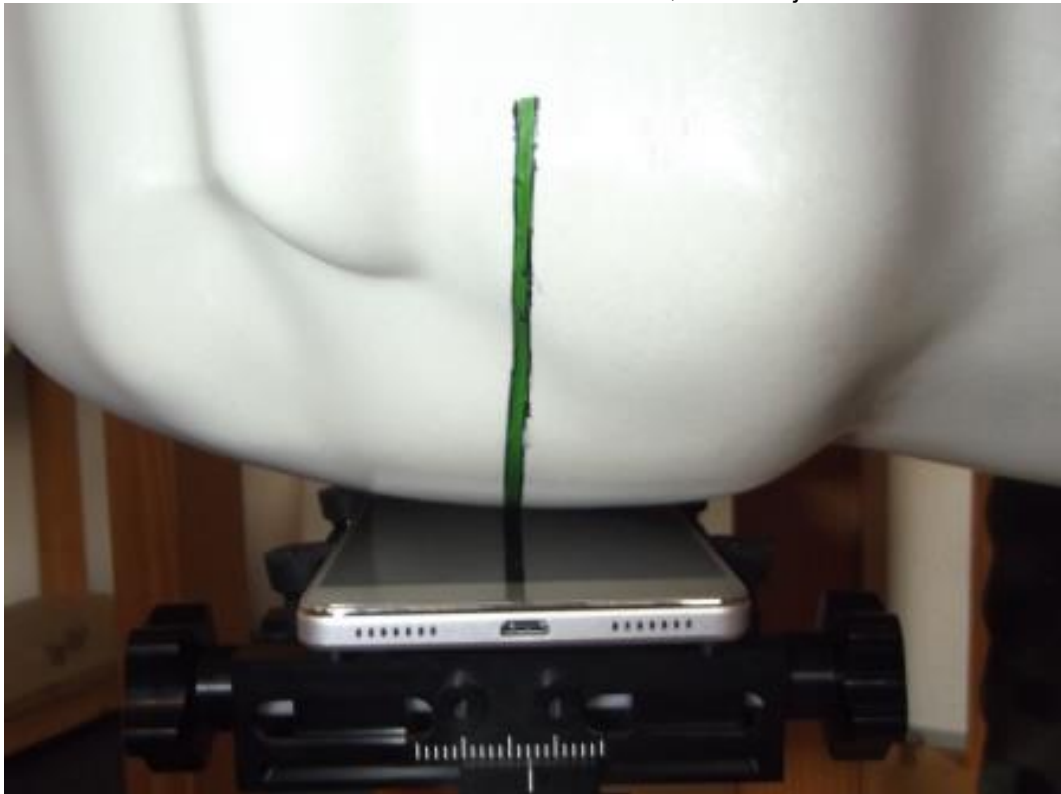
Photo 12: Position d'essai main droite, contre la joue
