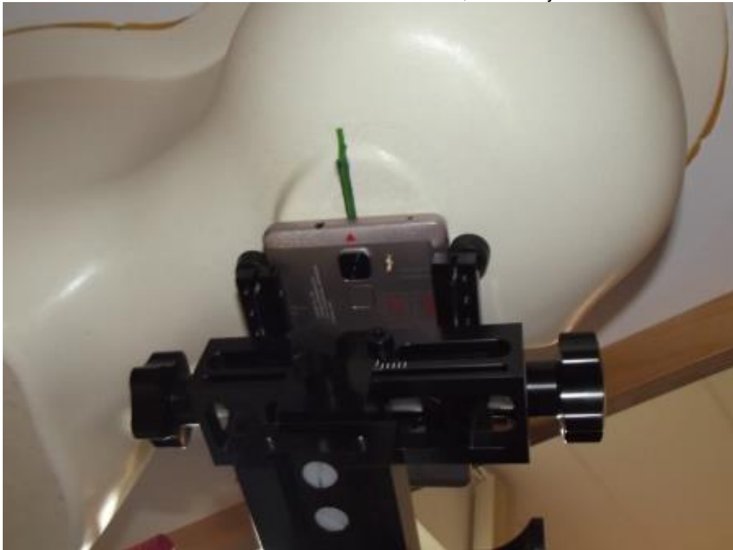
Photo 14: Position d'essai main droite, incliné 15°
