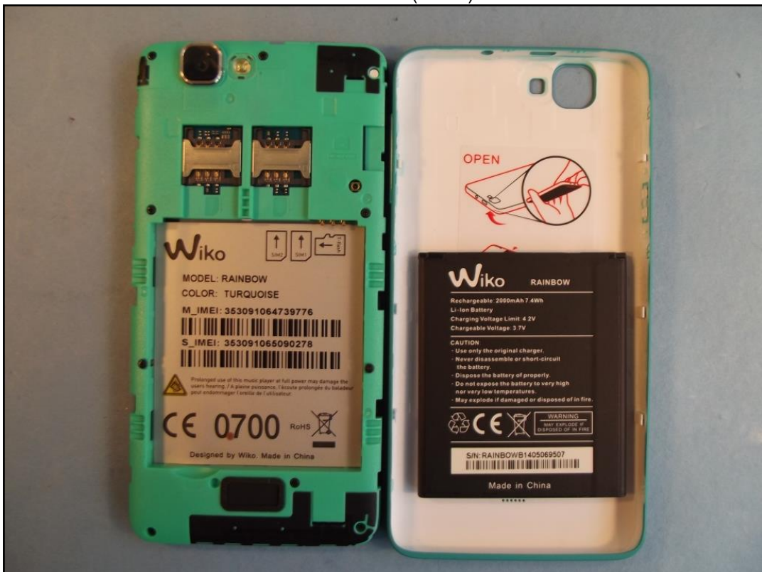
Photo 6: EST – vue arrière (ouvert) sans batterie
