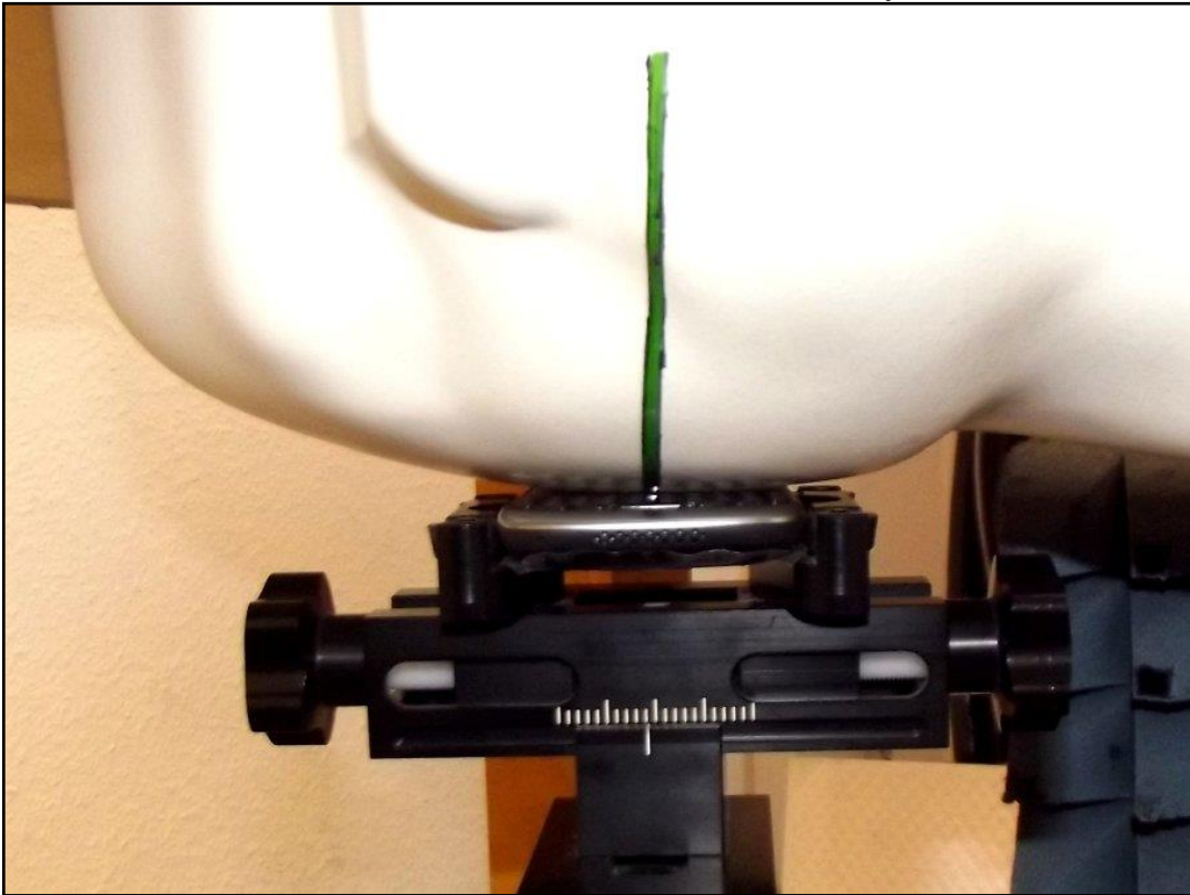
Photo 14: Position d'essai main droite, contre la joue
