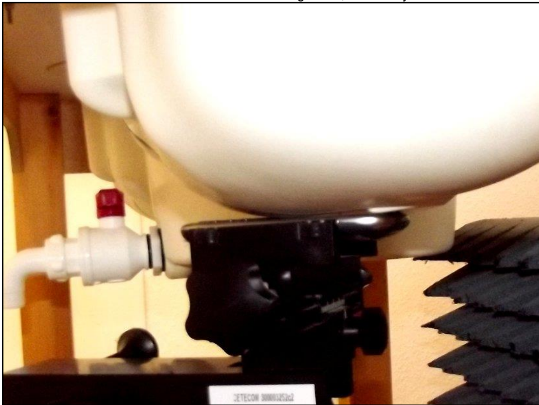
Photo 10: Position d'essai main gauche, contre la joue
