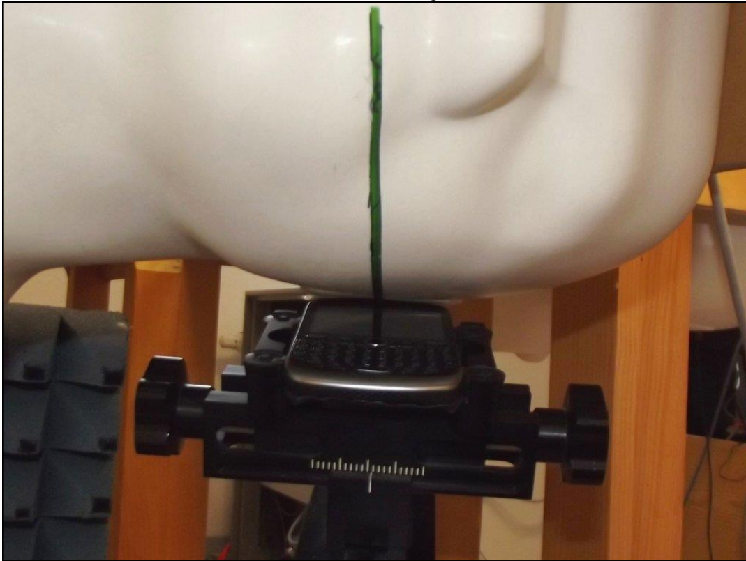
Photo 12: Position d'essai main gauche, incliné 15°
