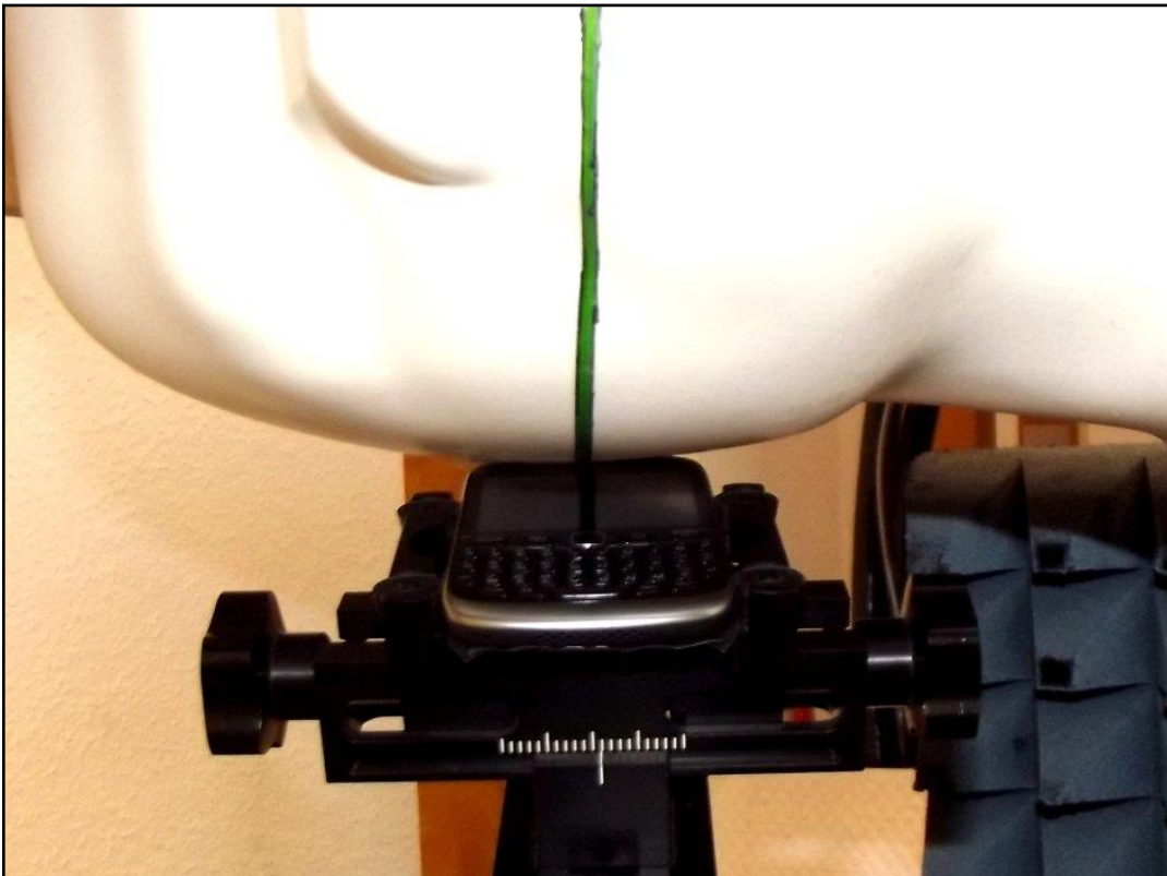
Photo 16: Position d'essai main droite, incliné 15°
