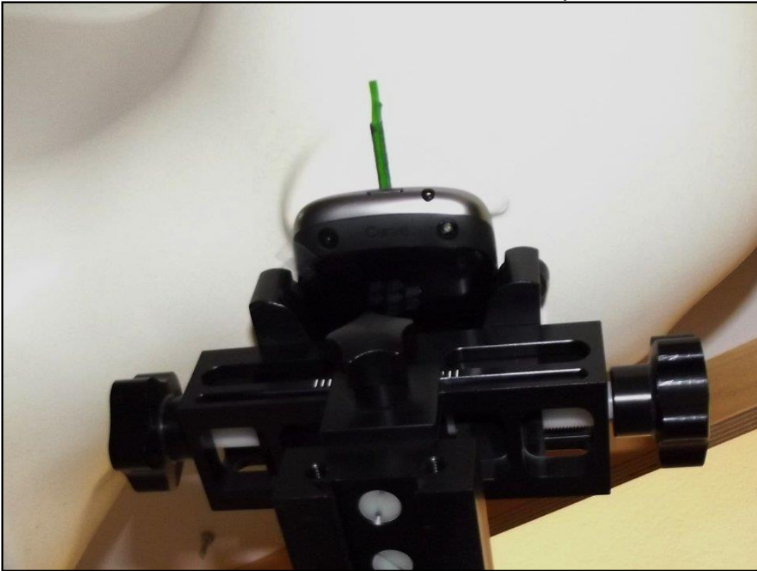
Photo 16: Position d'essai main droite, incliné 15°
