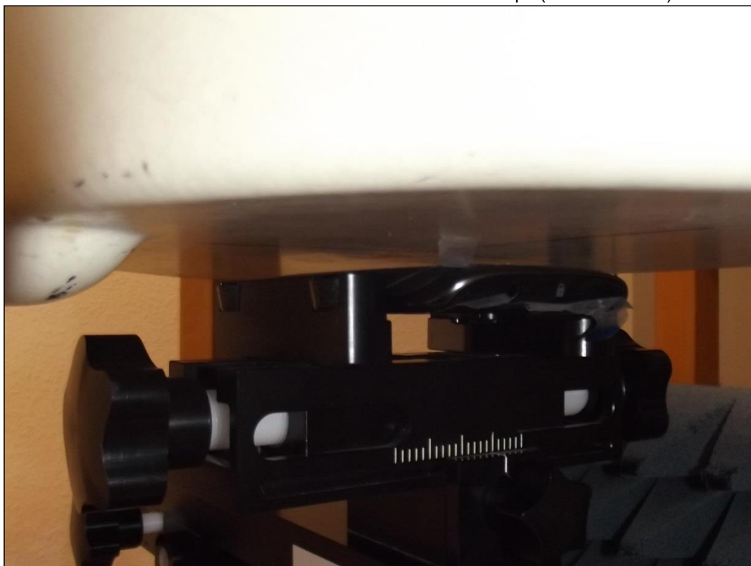
Photo 11: Position d'essai face arrière contre le corps (distance 5 mm)
