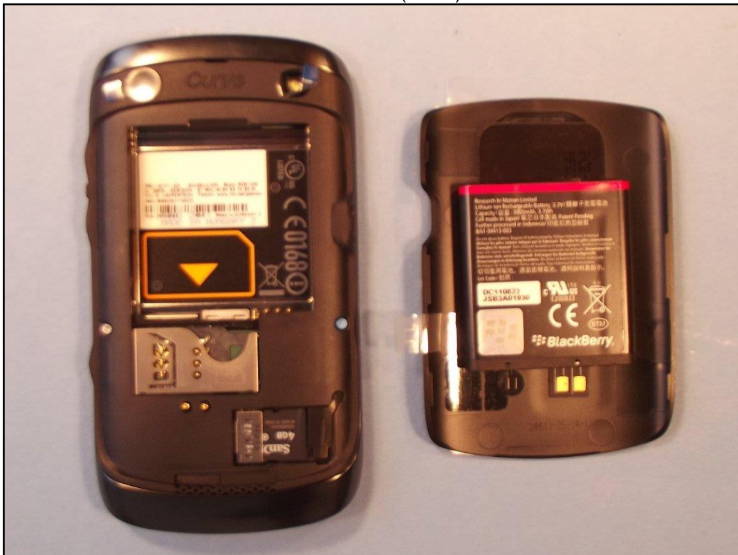
Photo 6: EST – vue arrière (ouvert) sans batterie
