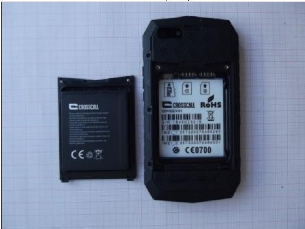
Photo 6: EST – vue arrière (ouvert) sans batterie
