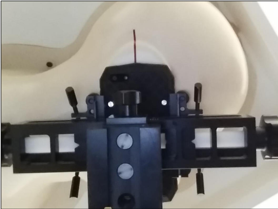
Photo 16: Position d'essai main droite, incliné 15°
