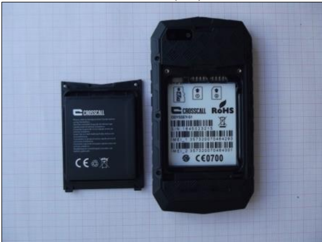
Photo 6: EST – vue arrière (ouvert) sans batterie
