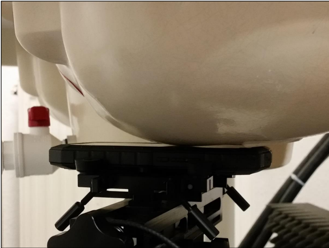
Photo 10: Position d'essai main gauche, contre la joue
