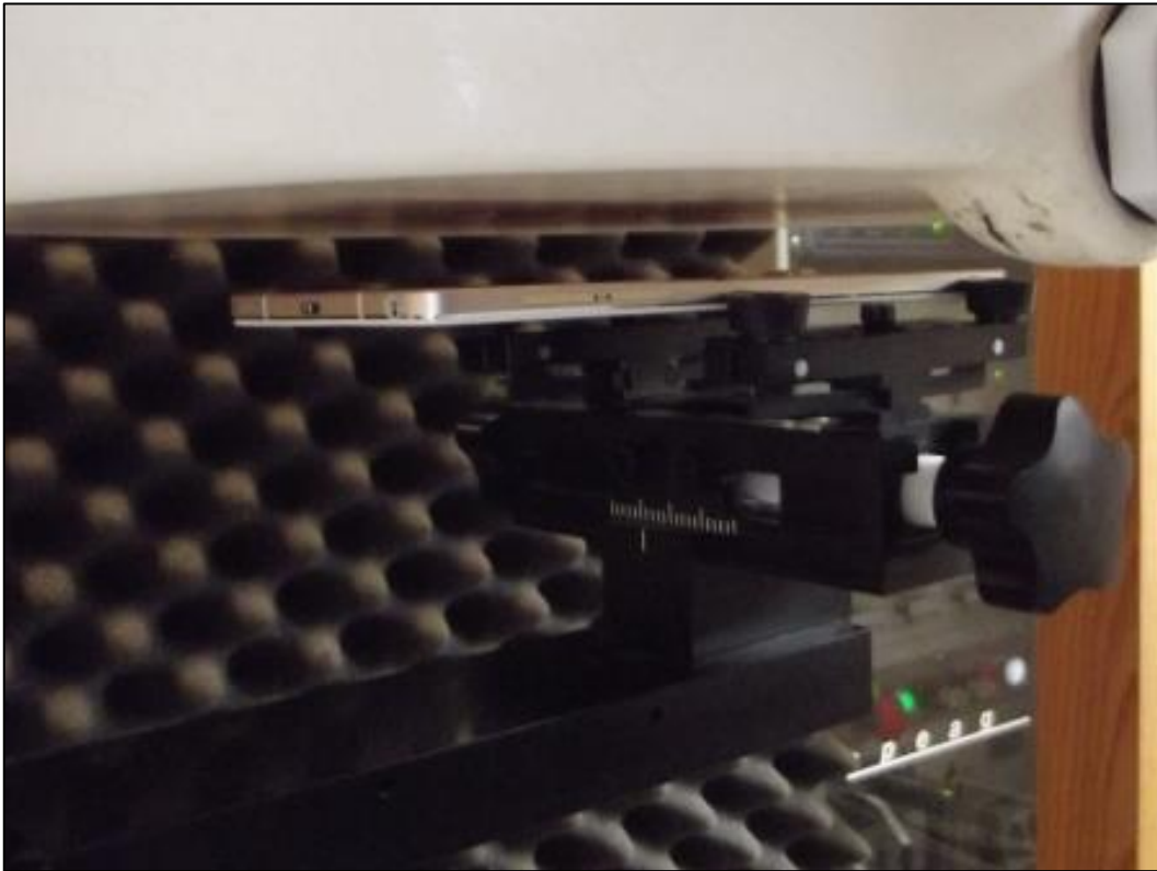
Photo 8: Position d'essai face du côté gauche contre le corps (distance 15 mm)
