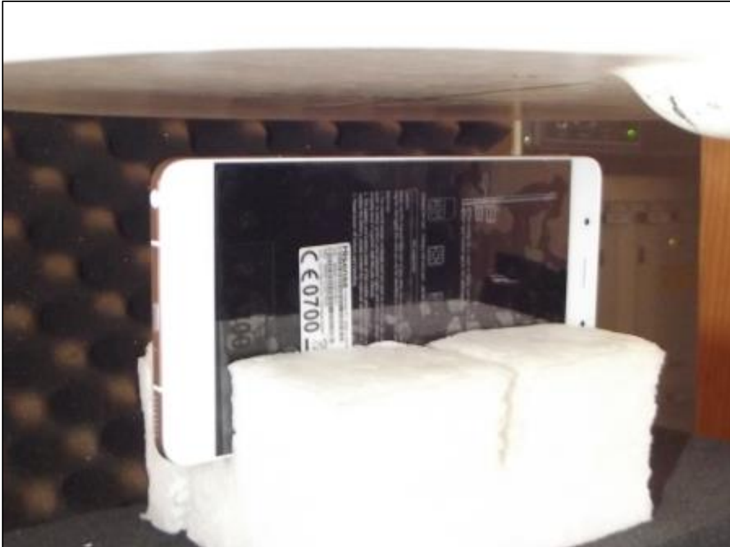
Photo 8: Position d'essai face du côté gauche contre le corps (distance 15 mm)
