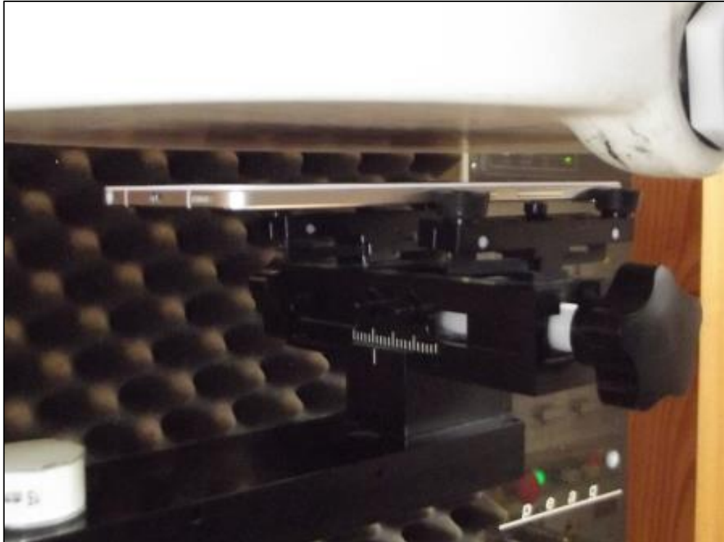
Photo 6: Position d'essai face avant contre le corps (distance 15 mm)
