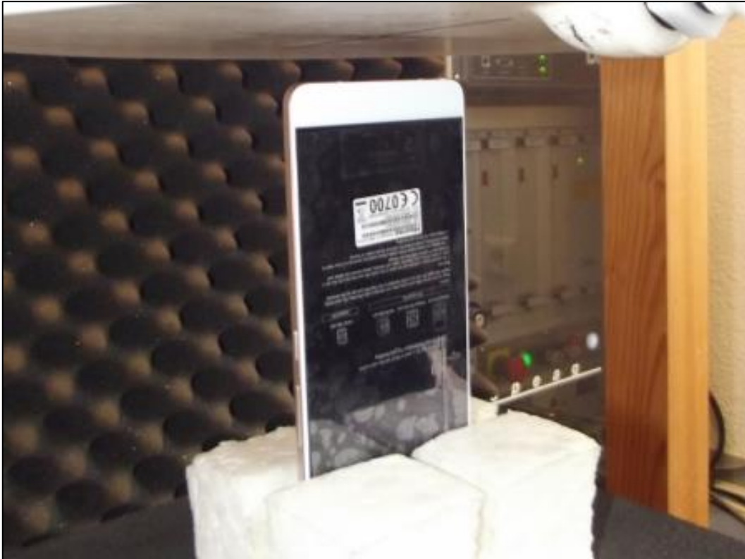
Photo 11: Position d'essai face du dessous contre le corps (distance 15 mm)
