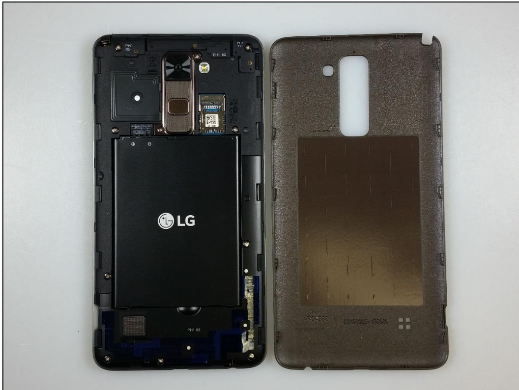
Photo 5: EST – vue arrière (ouvert) avec batterie
