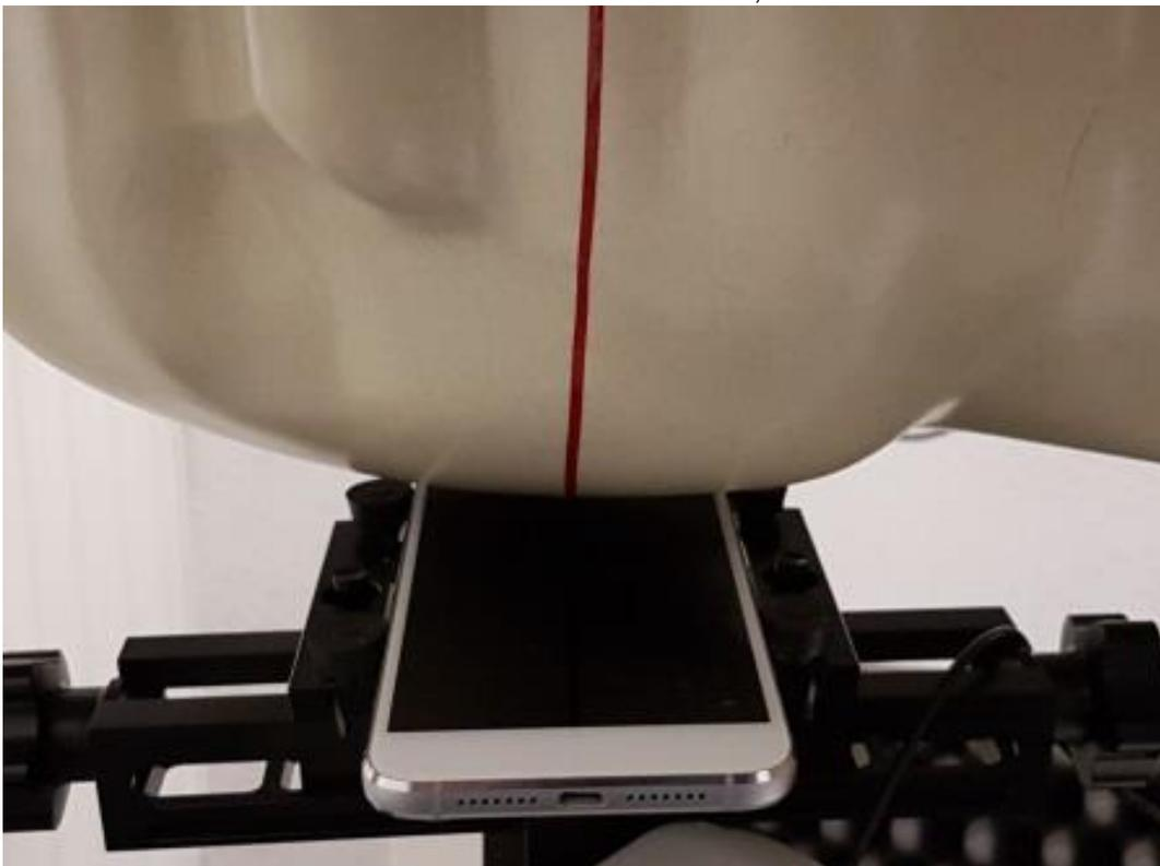
Photo 15: Position d'essai main droite, incliné 15°
