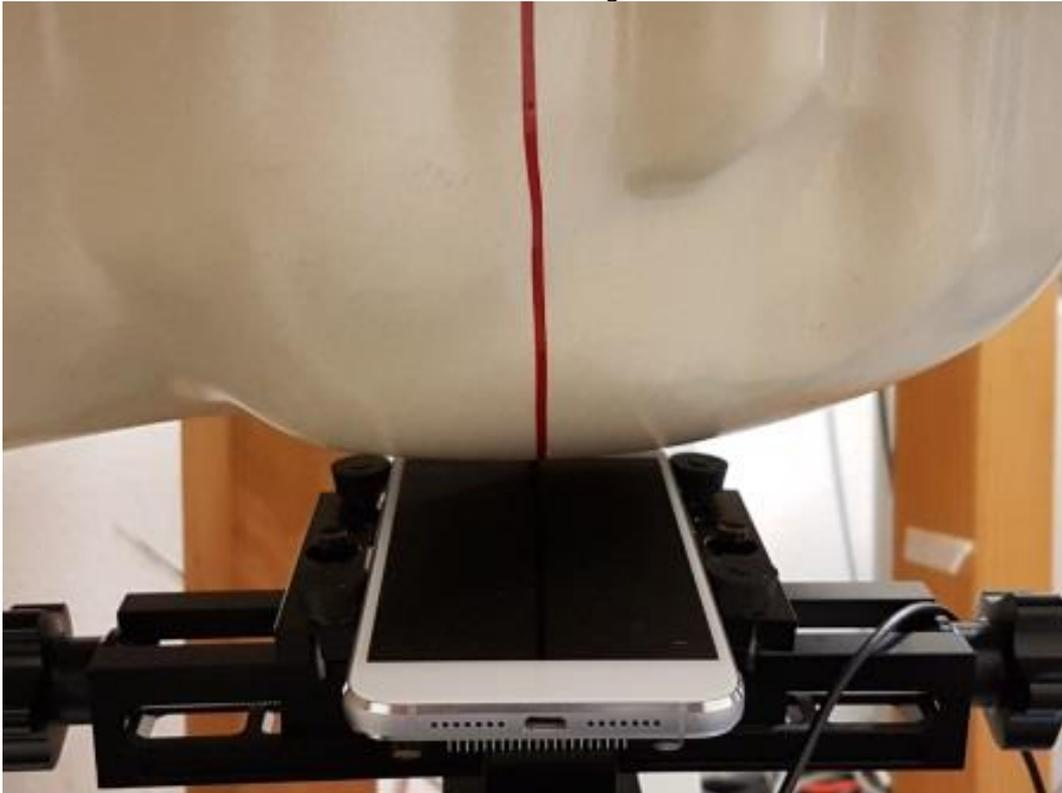
Photo 10: Position d'essai main gauche, incliné 15°
