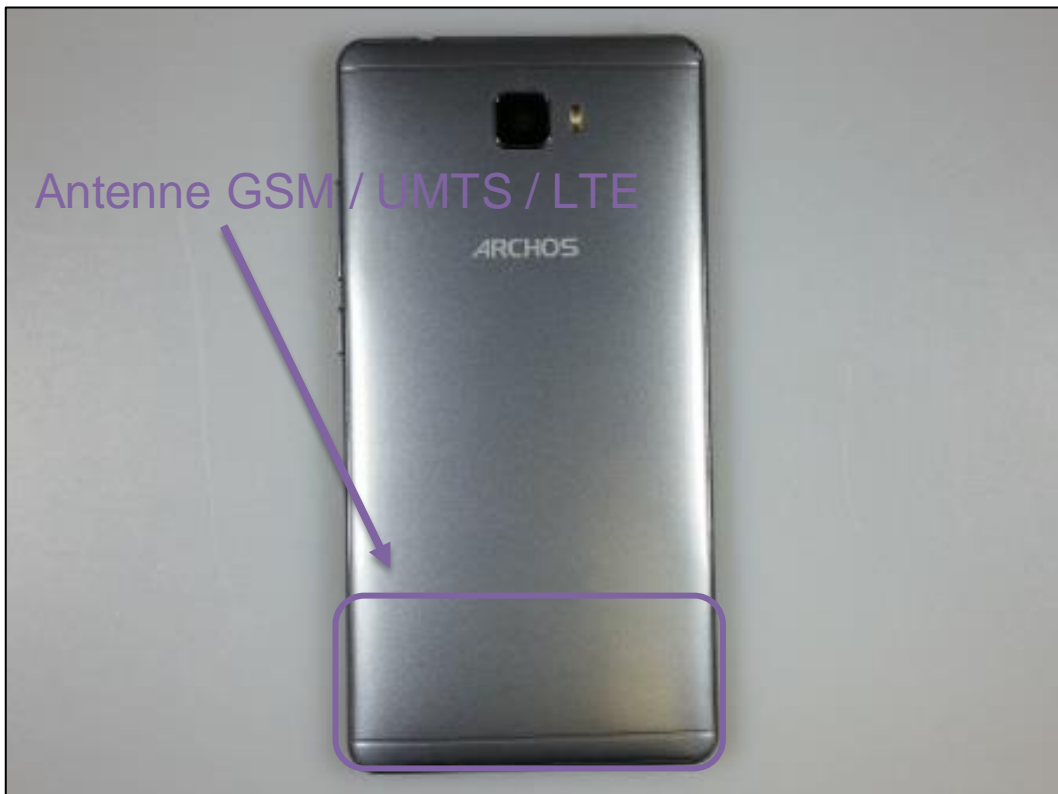
Photo 4: EST – vue arrière
