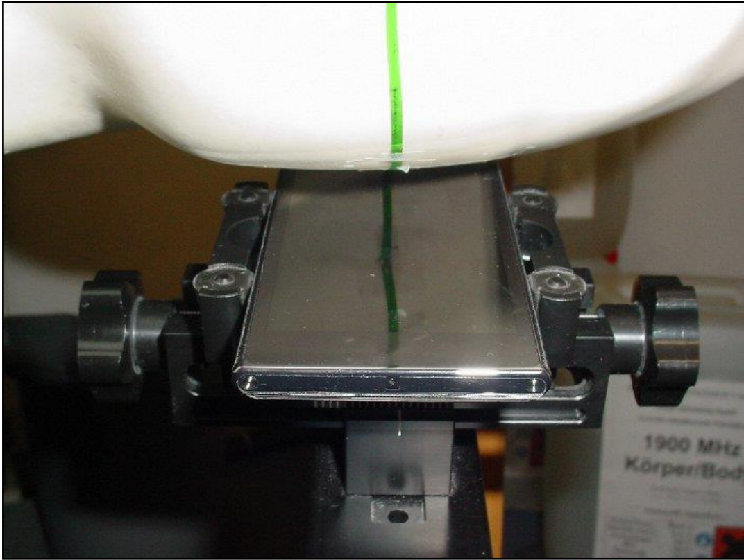
Photo 12: Position d'essai main gauche, incliné 15°
