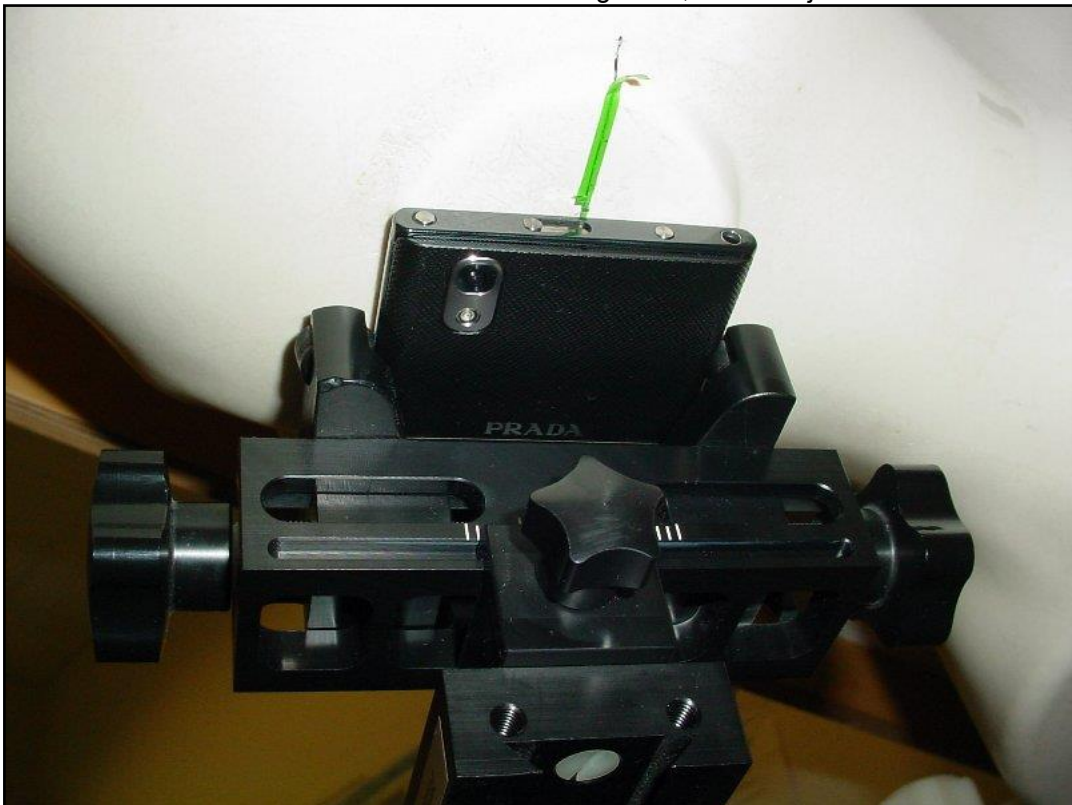
Photo 10: Position d'essai main gauche, contre la joue
