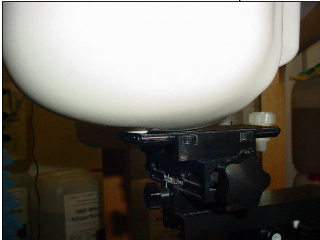
Photo 14: Position d'essai main droite, contre la joue
