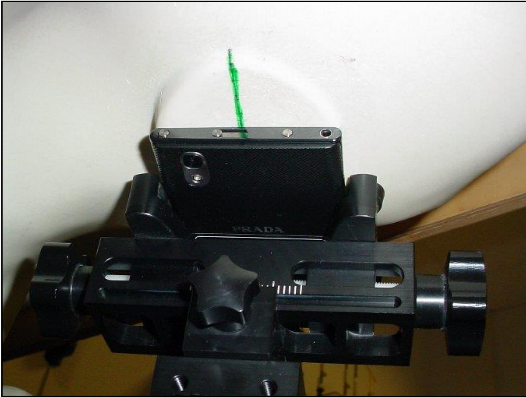
Photo 16: Position d'essai main droite, incliné 15°
