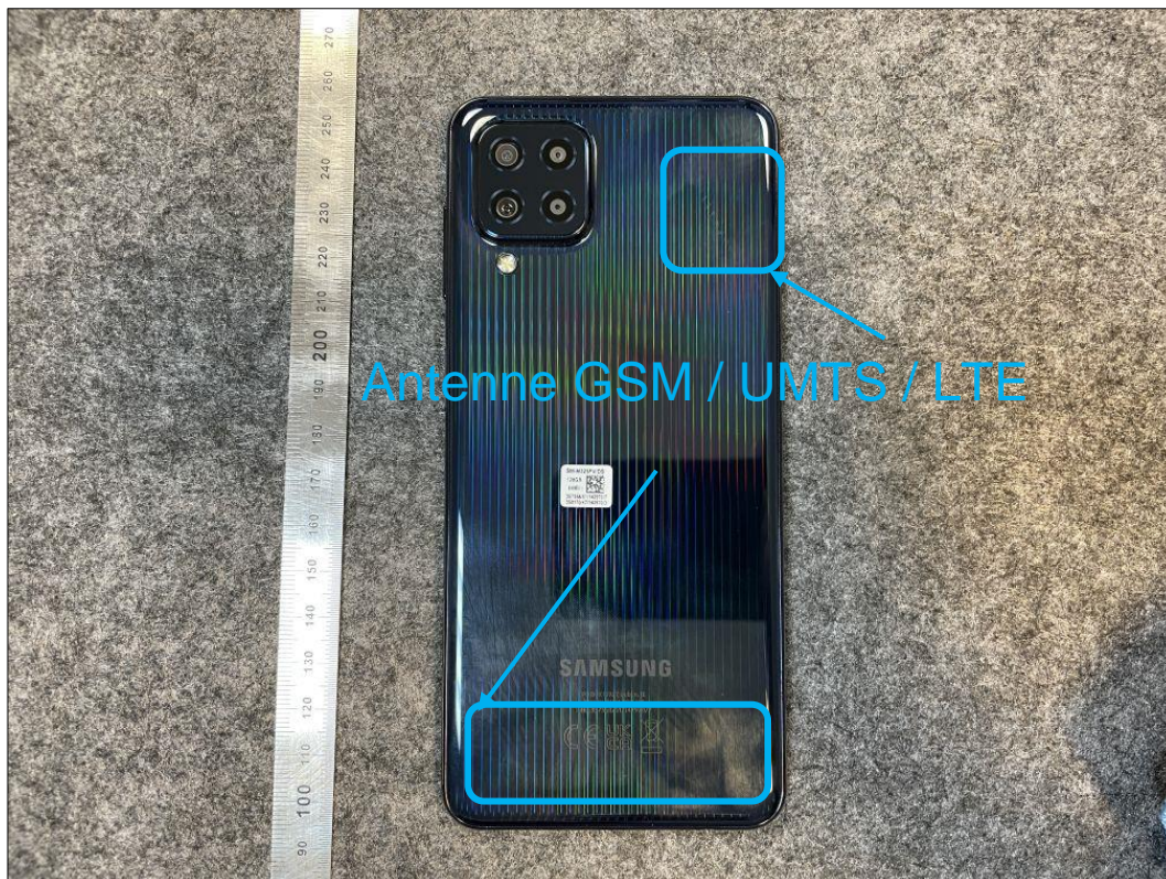
Photo 4: EST – vue arrière
