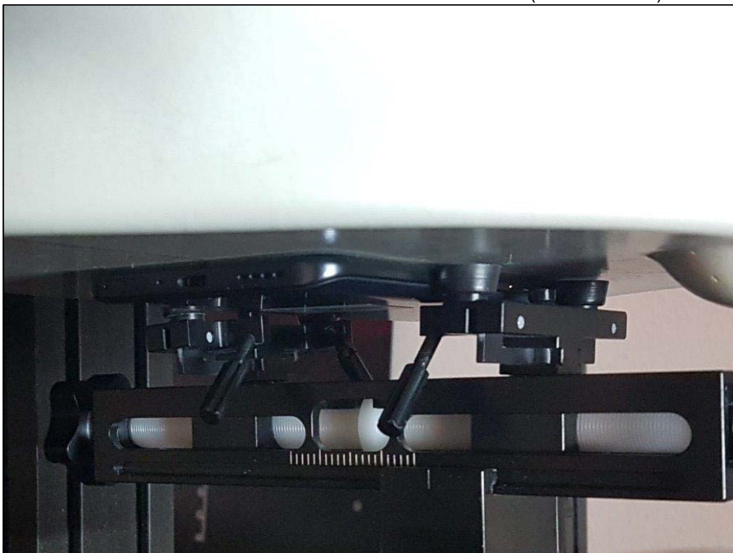
Photo 7: Position d'essai face avant contre le membre (distance 0 mm)
