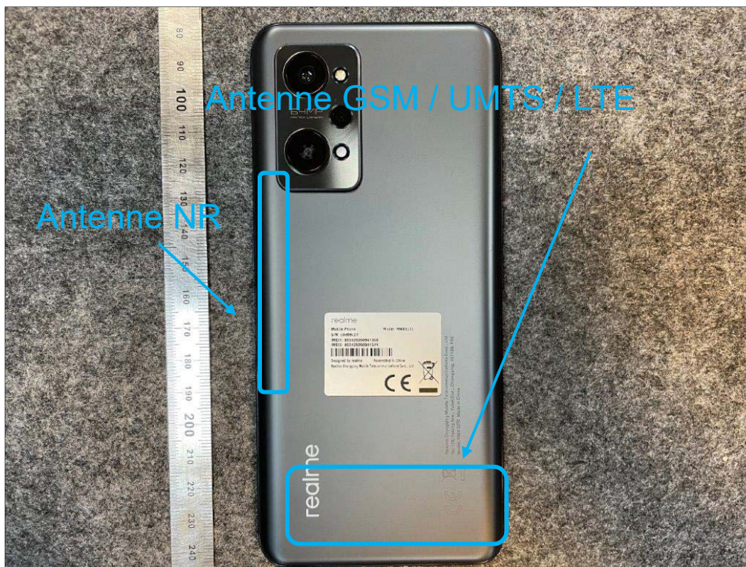
Photo 4: EST – vue arrière
