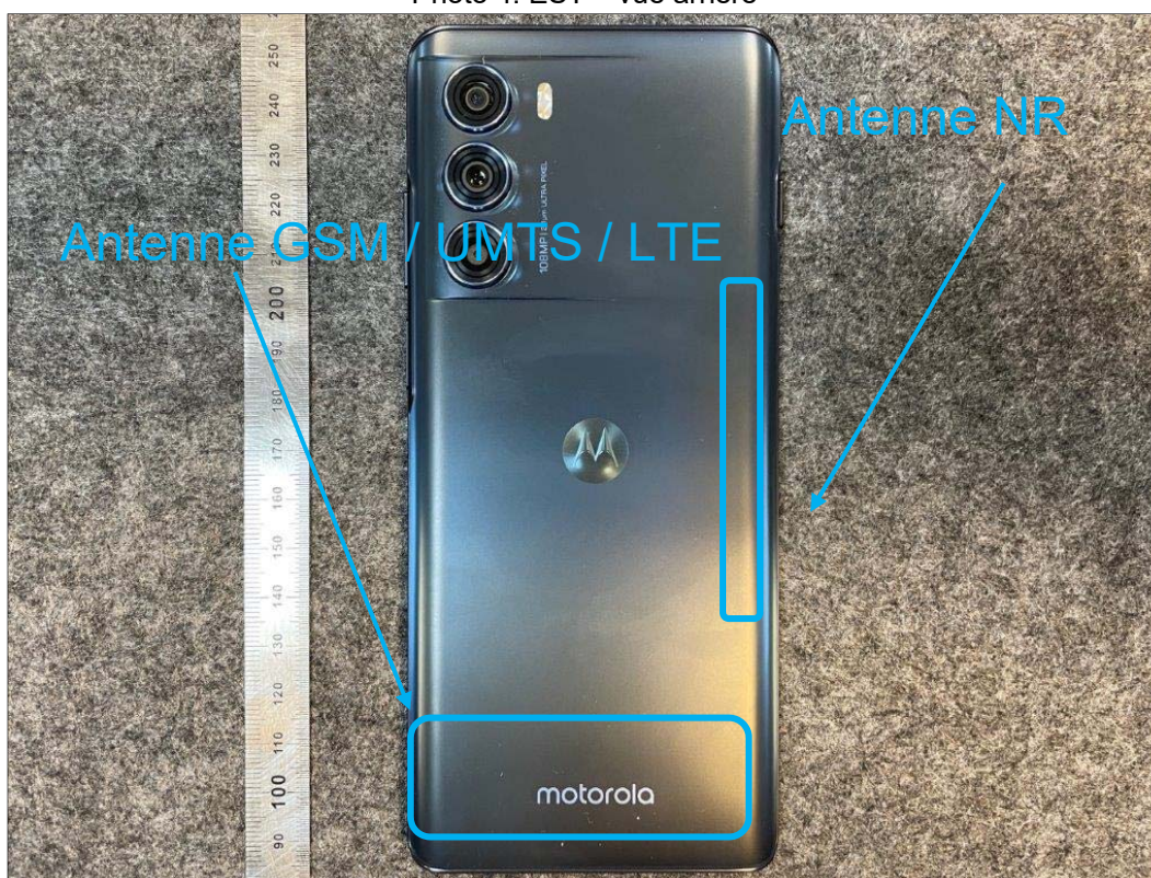
Photo 4: EST – vue arrière
