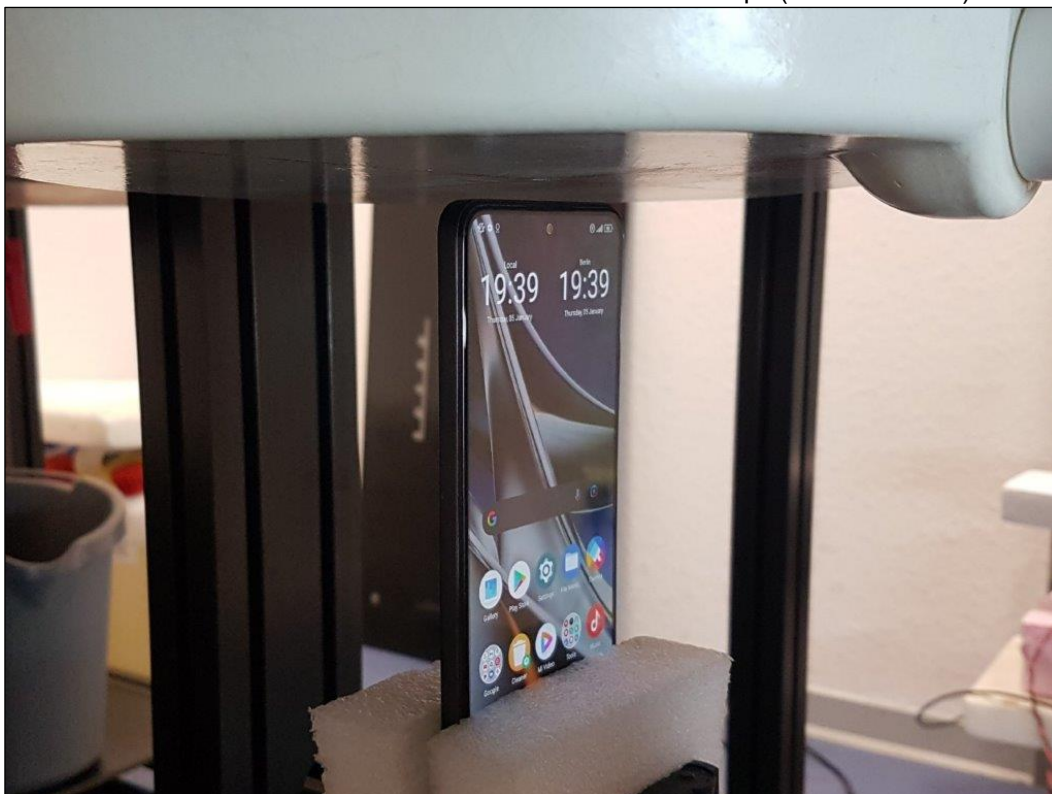
Photo 11: Position d'essai face du dessus contre le corps (distance 5 mm)
