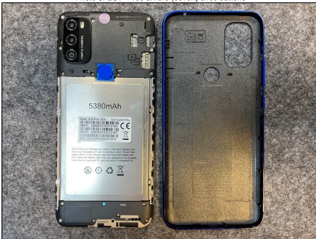
Photo 5: EST – vue arrière (ouvert) avec batterie
