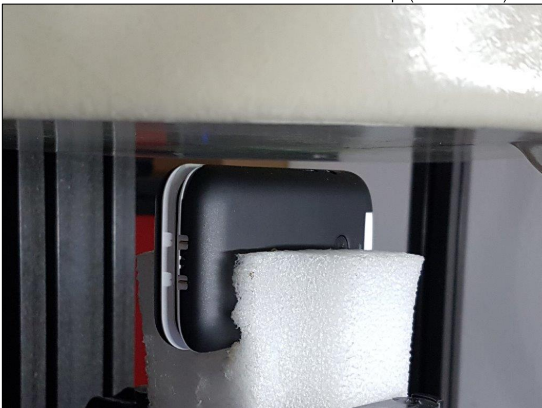
Photo 11: Position d'essai face du côté droite contre le corps (distance 5 mm)
