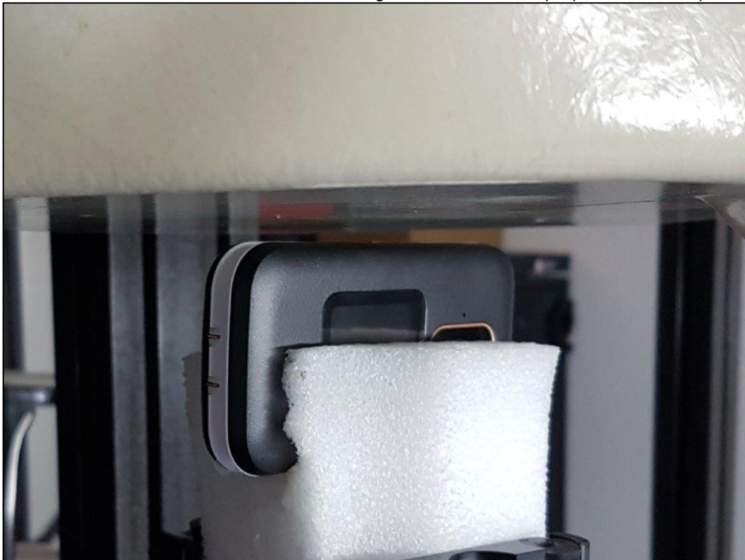
Photo 11: Position d'essai face du côté droite contre le corps (distance 5 mm)
