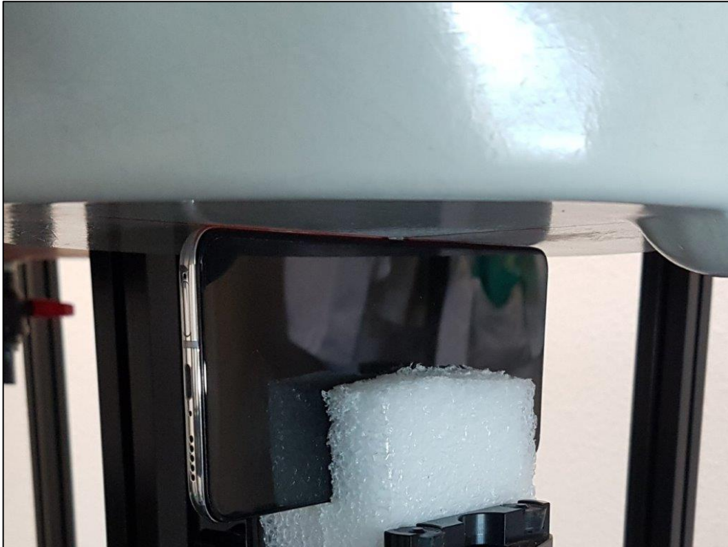
Photo 10: Position d'essai face du côté droit contre le membre (distance 0 mm)
