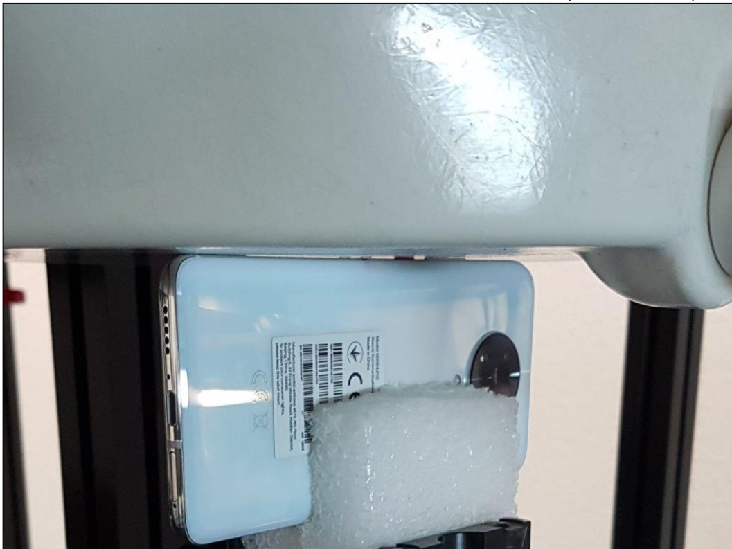
Photo 10: Position d'essai face du côté droit contre le membre (distance 0 mm)
