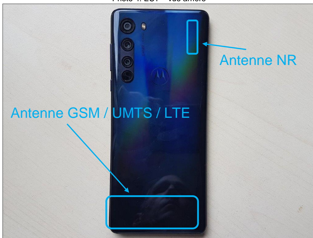
Photo 4: EST – vue arrière
