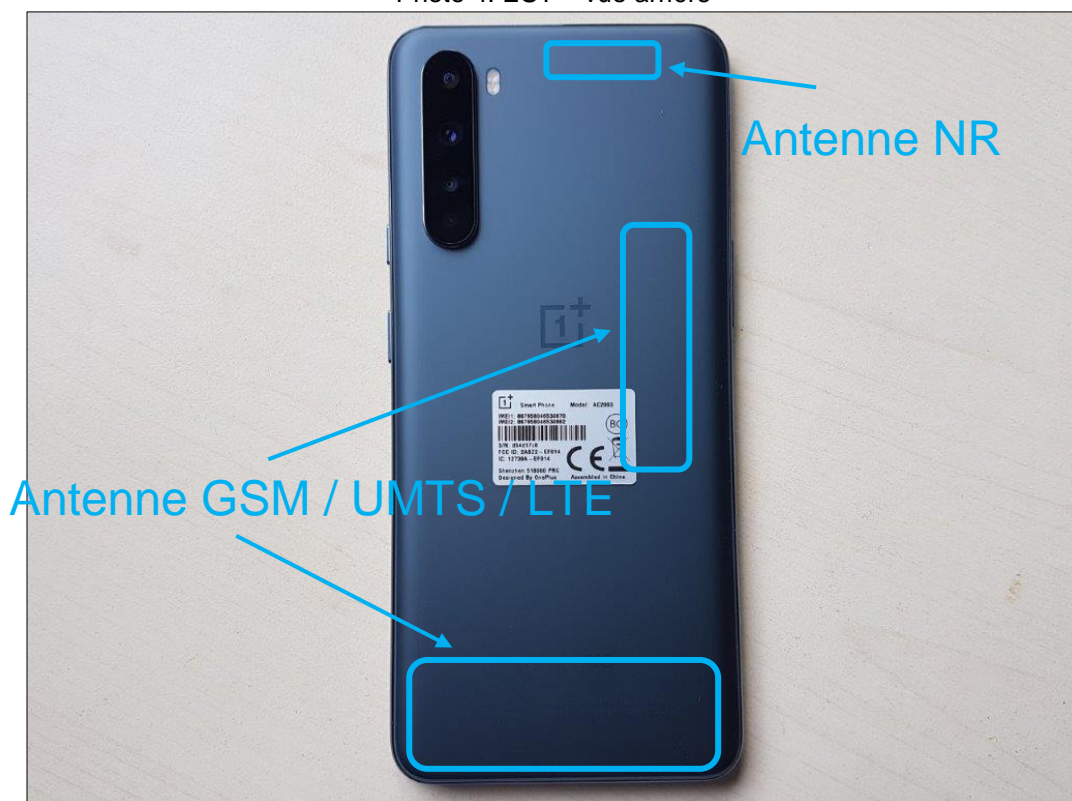
Photo 4: EST – vue arrière
