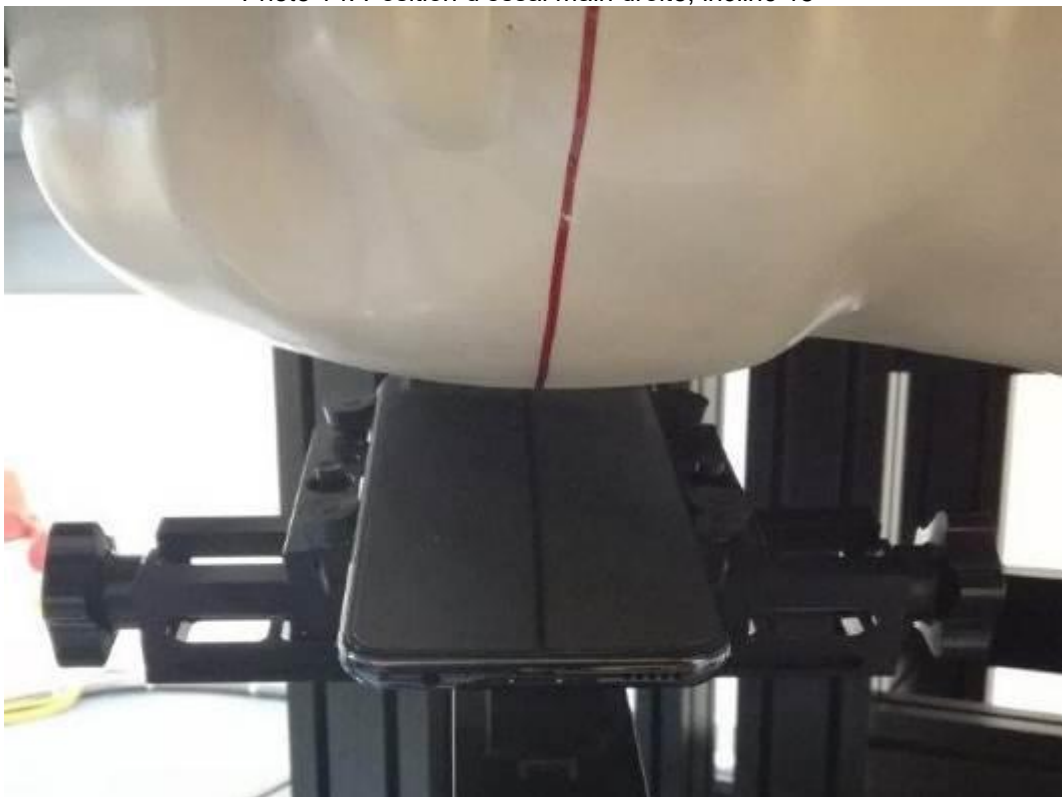
Photo 14: Position d'essai main droite, incliné 15°
