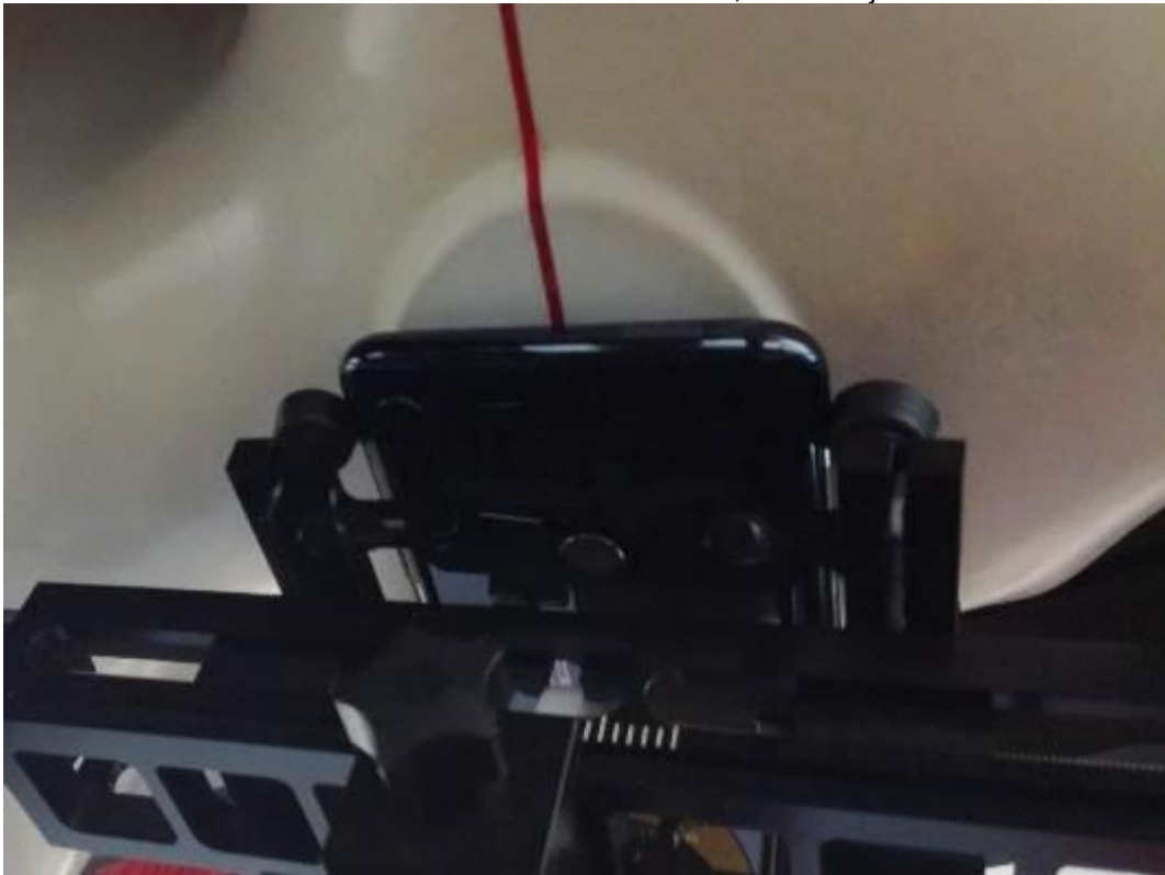
Photo 14: Position d'essai main droite, incliné 15°
