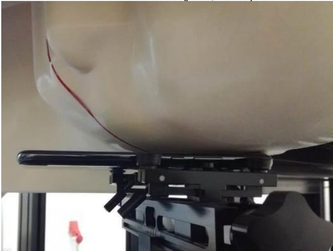
Photo 8: Position d'essai main gauche, contre la joue
