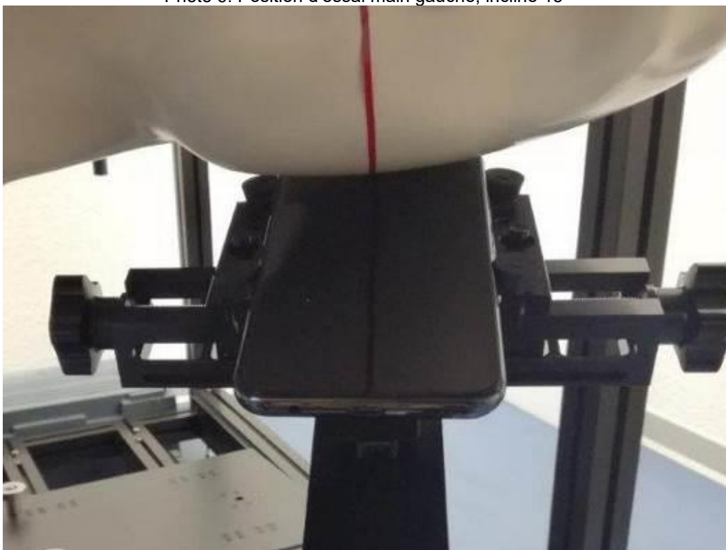
Photo 10: Position d'essai main gauche, incliné 15°
