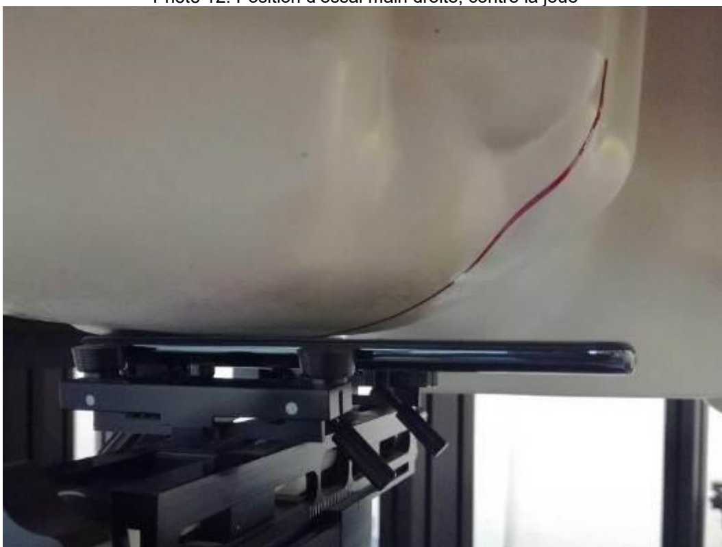
Photo 12: Position d'essai main droite, contre la joue
