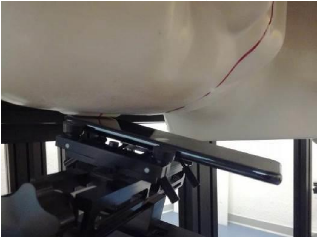
Photo 15: Position d'essai main droite, incliné 15°
