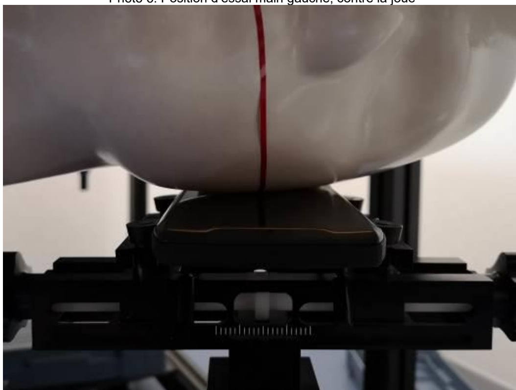
Photo 6: Position d'essai main gauche, contre la joue
