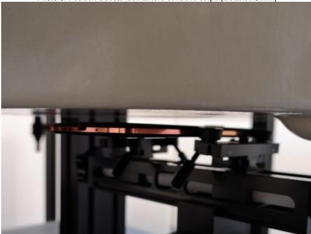
Photo 8: Position d'essai face arrière contre le corps (distance 5 mm)
