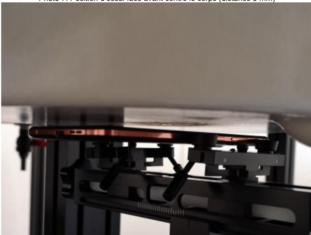
Photo 8: Position d'essai face arrière contre le corps (distance 5 mm)
