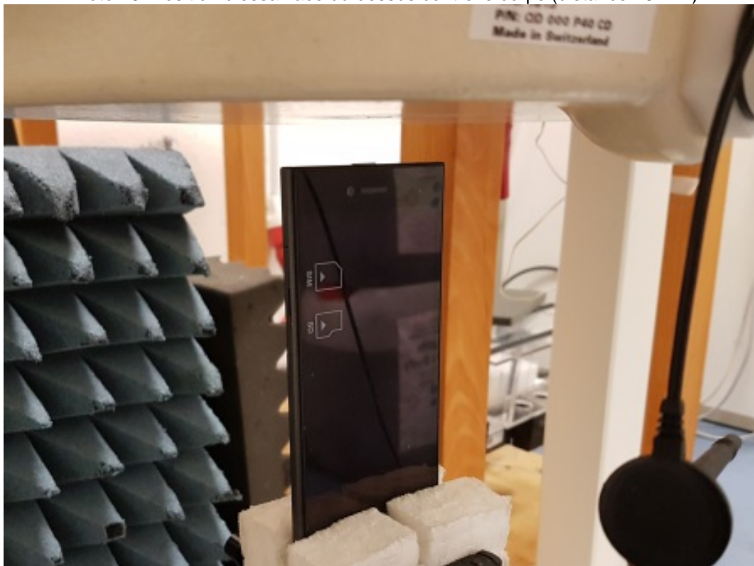
Photo 10: Position d'essai face du dessus contre le corps (distance 15 mm)
