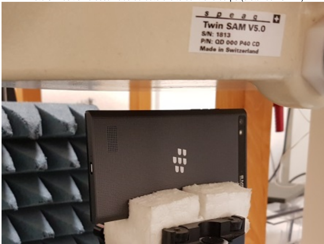
Photo 10: Position d'essai face du dessus contre le corps (distance 15 mm)
