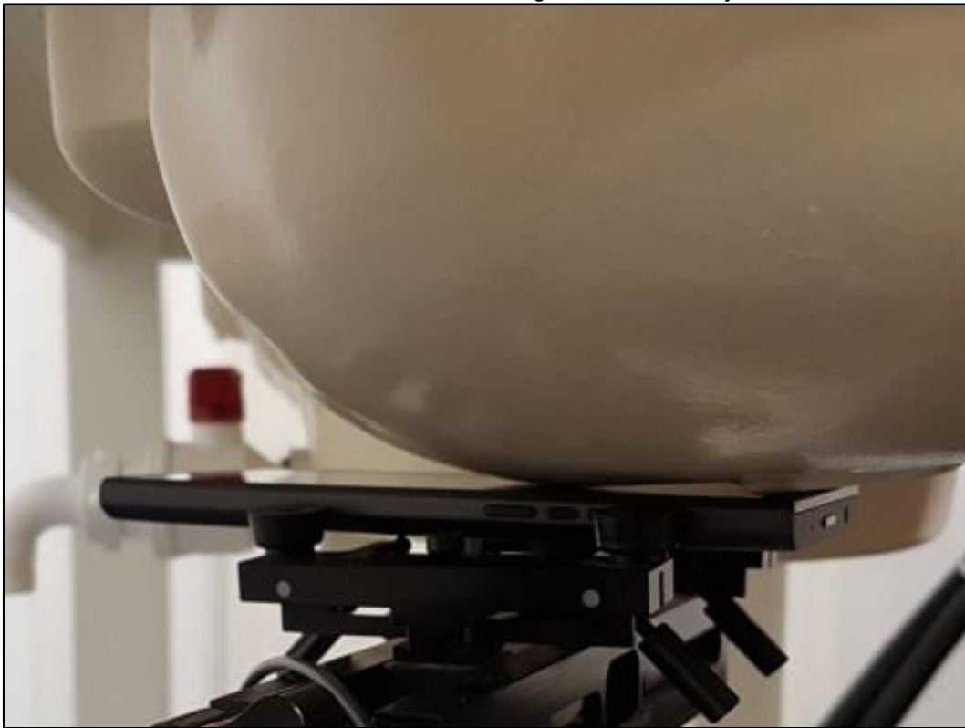
Photo 8: Position d'essai main gauche, contre la joue
