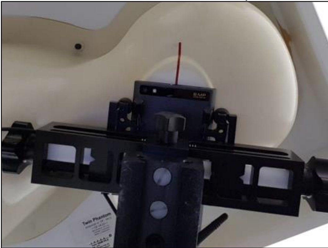
Photo 14: Position d'essai main droite, incliné 15°
