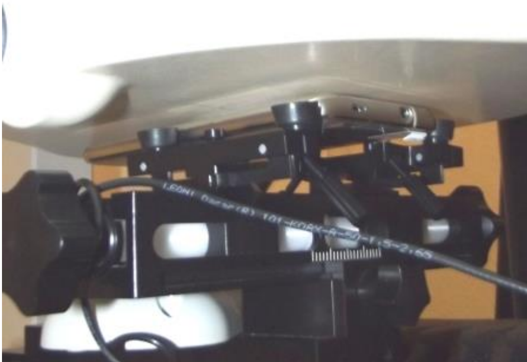
Photo 9: Position d'essai face arrière contre le corps (distance 5 mm)
