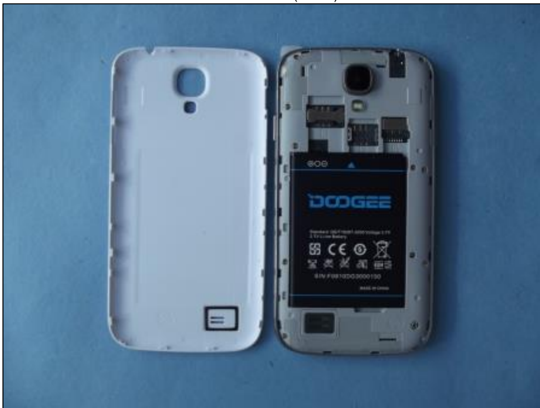
Photo 5: EST – vue arrière (ouvert) avec batterie
