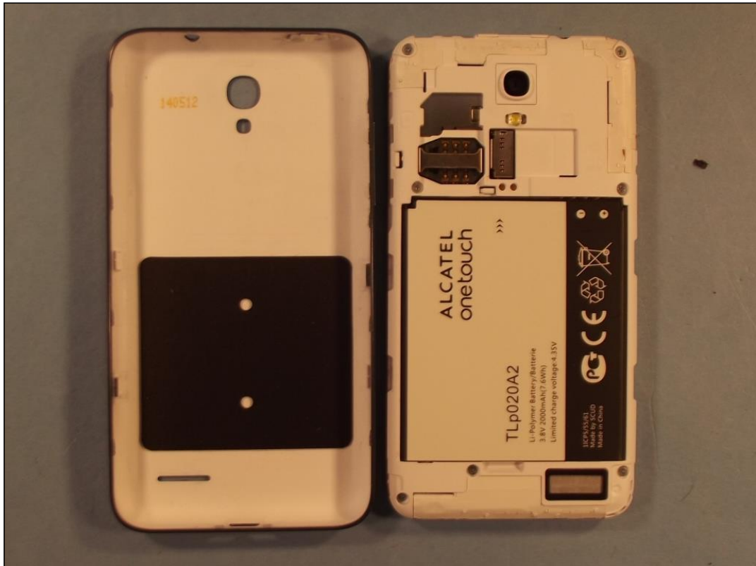
Photo 5: EST – vue arrière (ouvert) avec batterie
