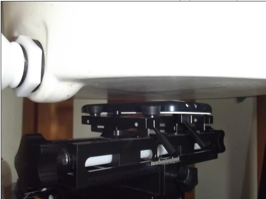
Photo 12: Position d'essai face arrière contre le corps (distance 10 mm)
