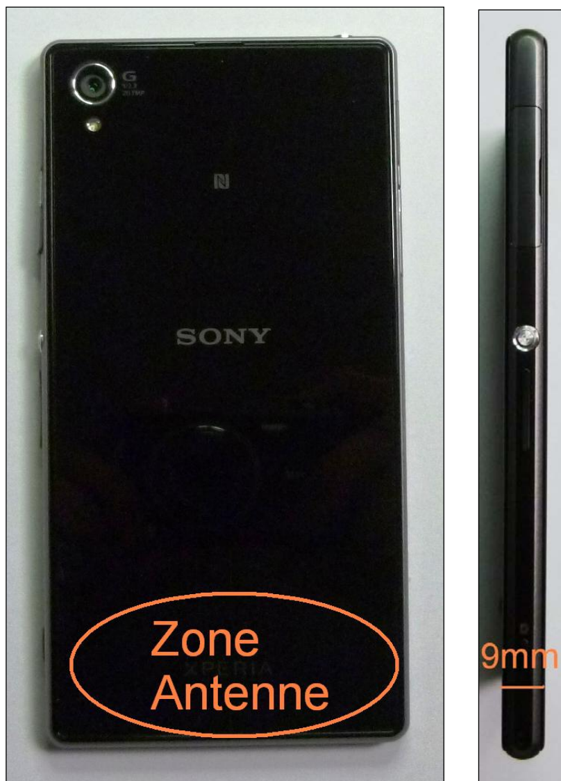
Fig. 18: Emplacement de l'antenne et épaisseur de l'équipement dans cette zone
