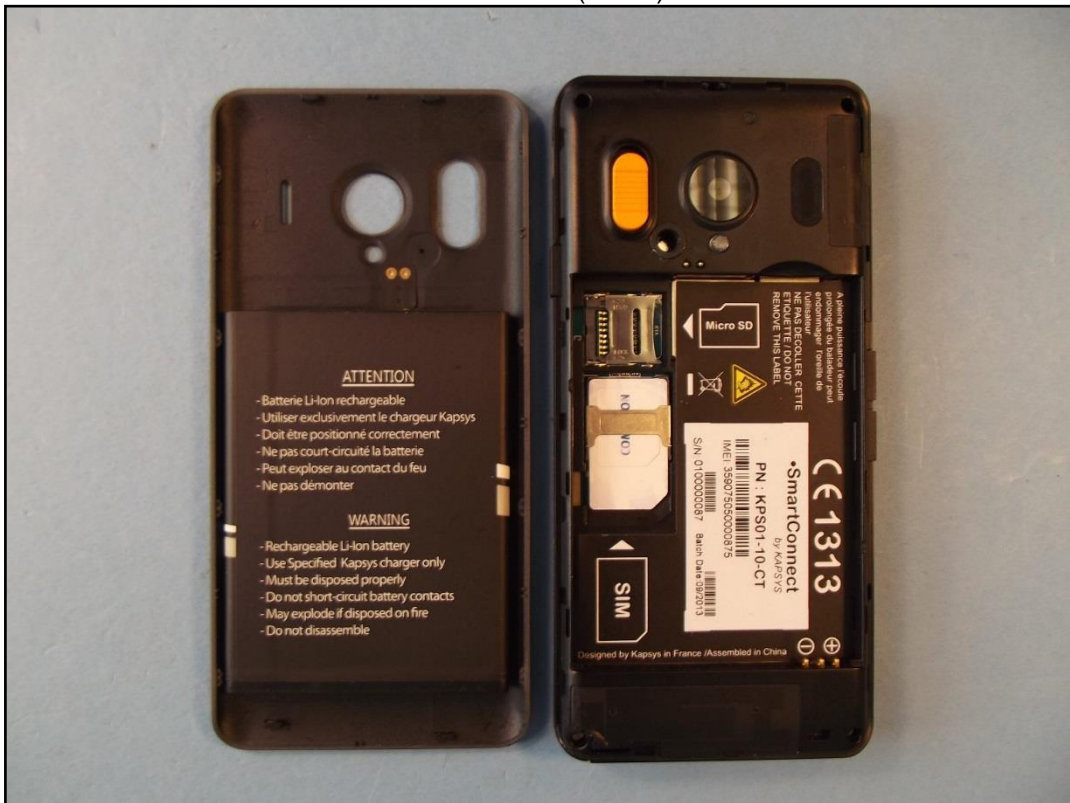
Photo 6: EST – vue arrière (ouvert) sans batterie
