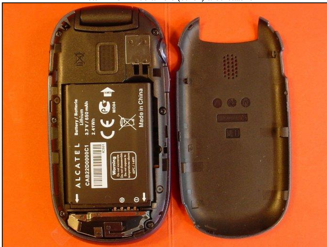
Photo 7: EST – vue arrière (ouvert) avec batterie
