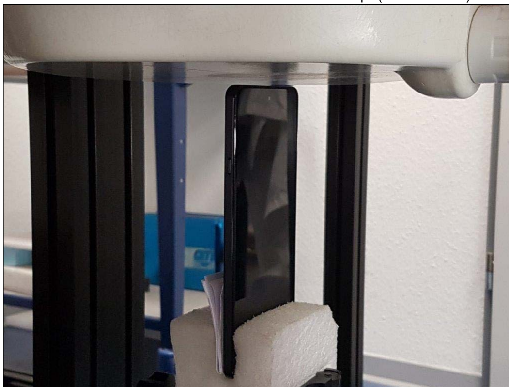
Photo 11: Position d'essai face du dessous contre le corps (distance 5 mm)
