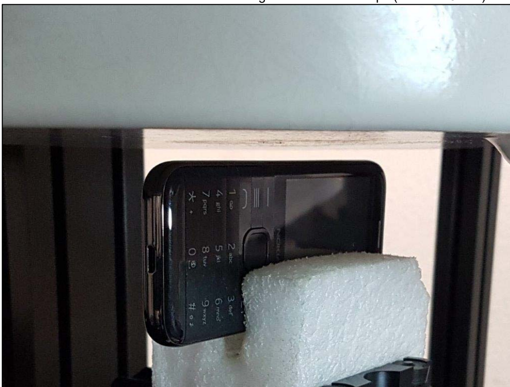
Photo 12: Position d'essai face du côté droite contre le corps (distance 5 mm)
