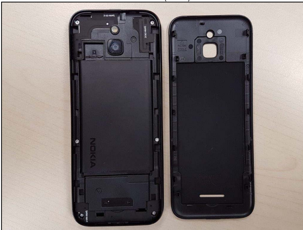
Photo 5: EST – vue arrière (ouvert) avec batterie
