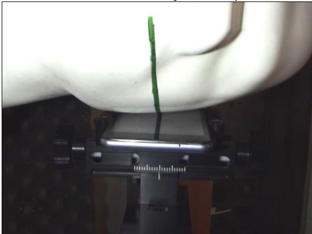
Photo 8: Position d'essai main gauche, contre la joue
