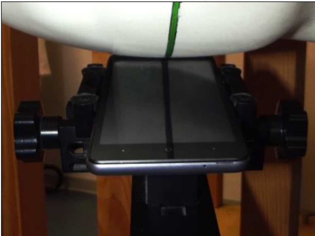
Photo 16: Position d'essai main droite, incliné 15°
