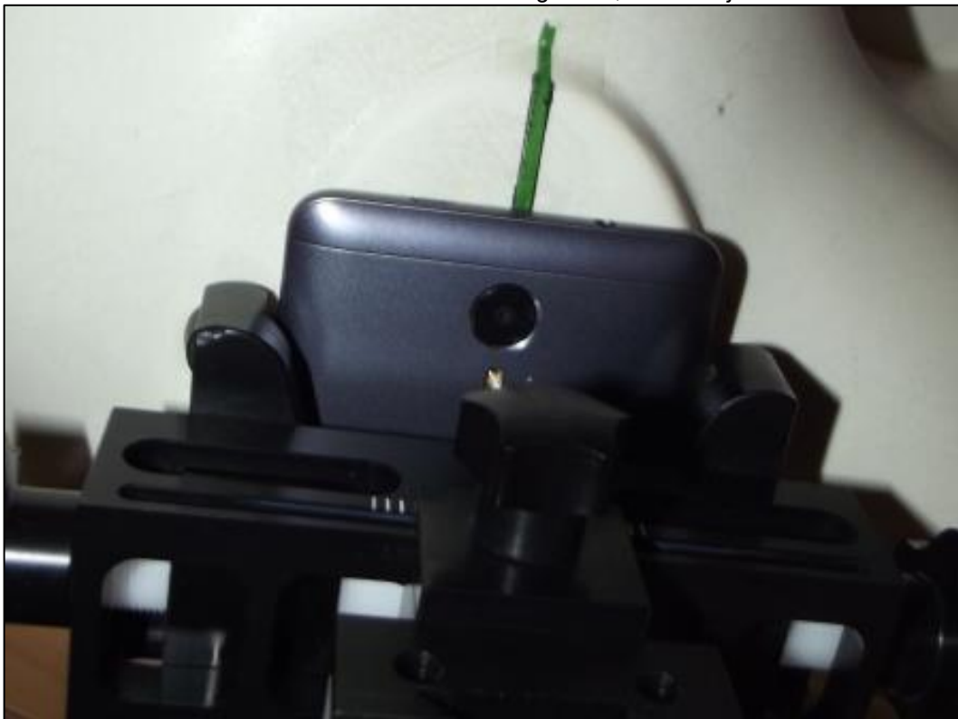
Photo 10: Position d'essai main gauche, contre la joue
