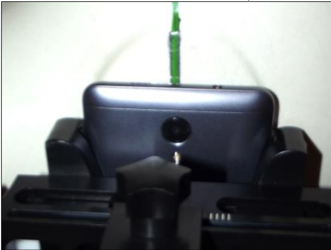
Photo 16: Position d'essai main droite, incliné 15°
