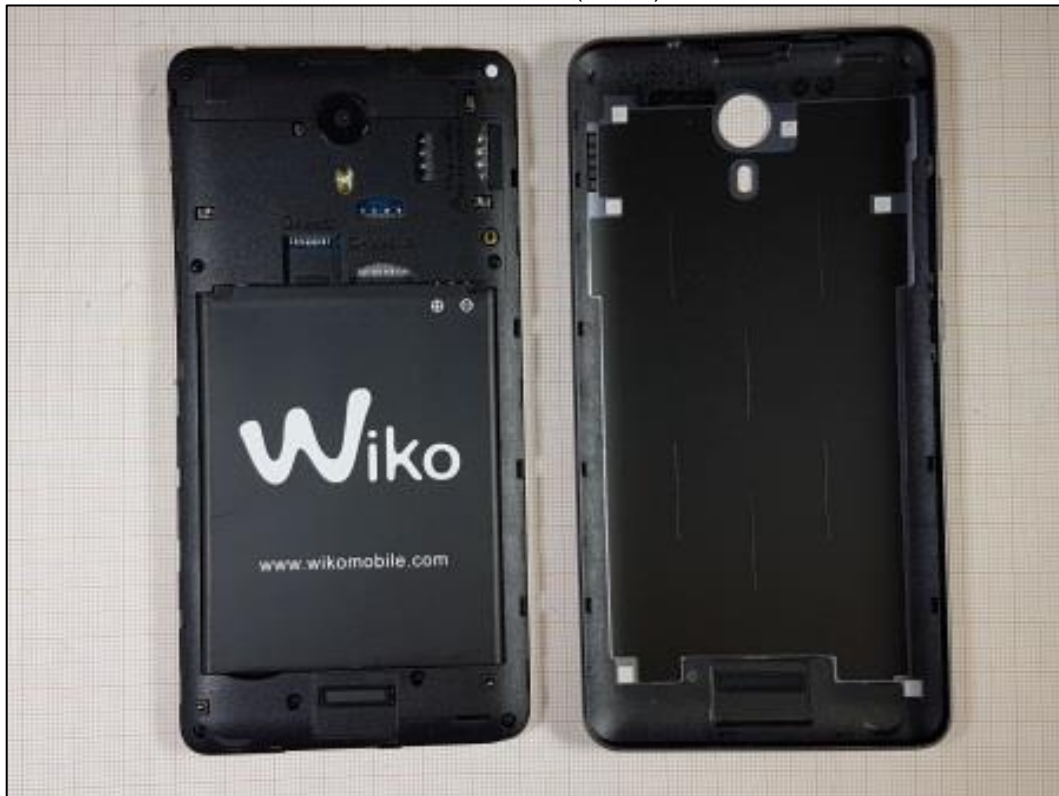
Photo 5: EST – vue arrière (ouvert) avec batterie
