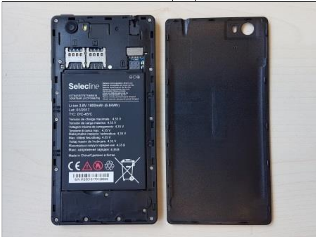
Photo 5: EST – vue arrière (ouvert) avec batterie
