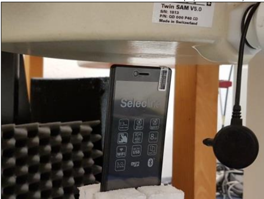
Photo 12: Position d'essai face du dessus contre le corps (distance 10 mm)
