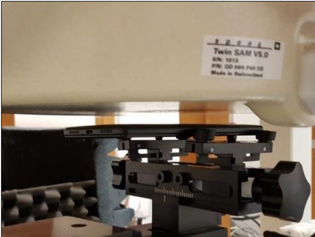
Photo 10: Position d'essai face du côté gauche contre le corps (distance 10 mm)
