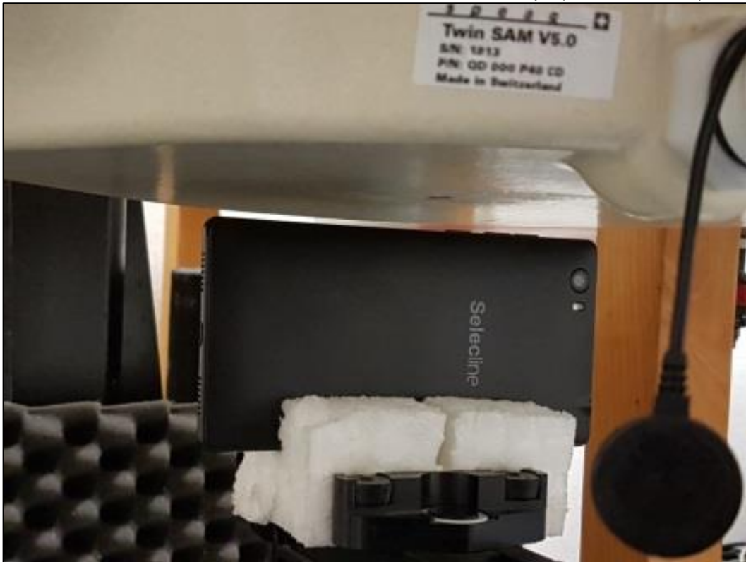
Photo 12: Position d'essai face du dessus contre le corps (distance 10 mm)
