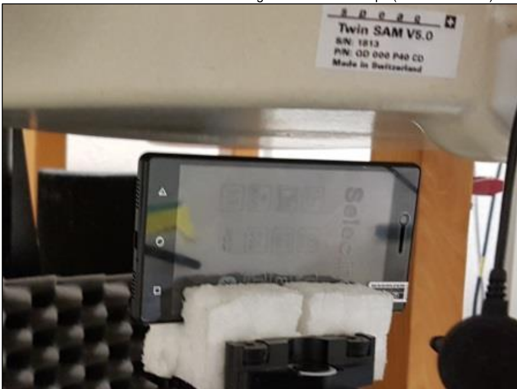
Photo 10: Position d'essai face du côté gauche contre le corps (distance 10 mm)
