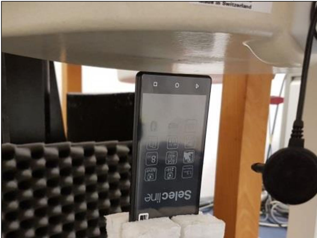
Photo 13: Position d'essai face du dessous contre le corps (distance 10 mm)
