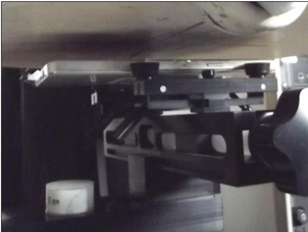
Photo 7: Position d'essai face avant contre le corps (distance 15 mm)
