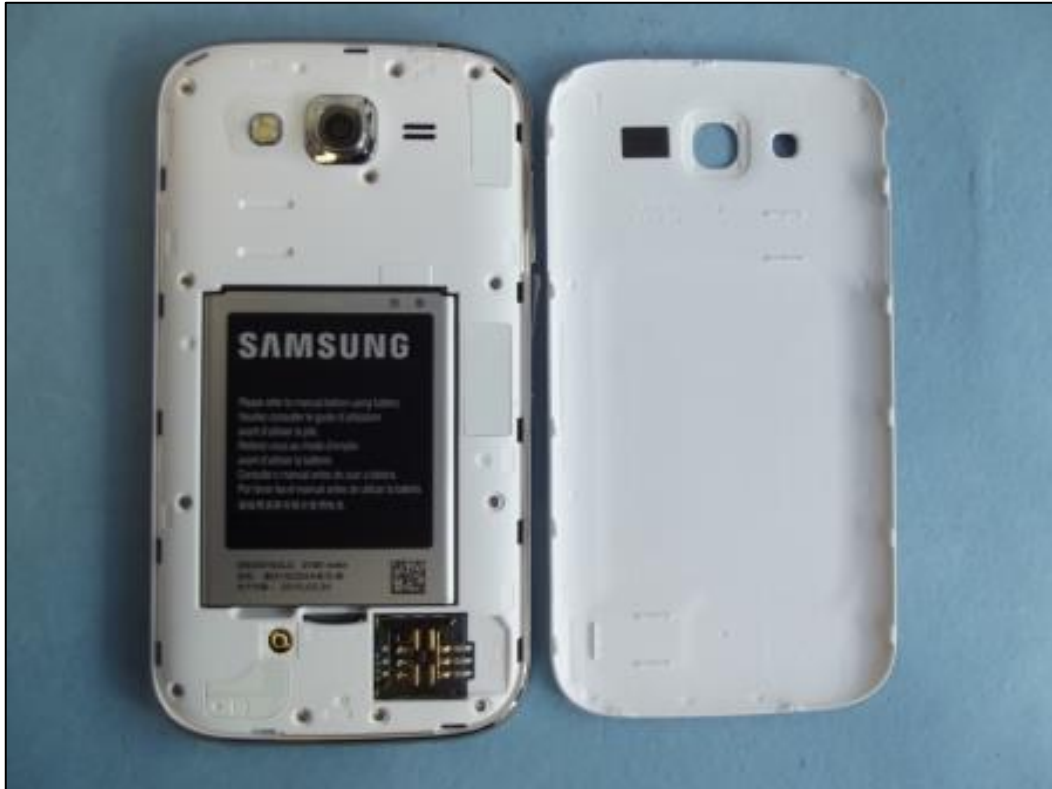
Photo 5: EST – vue arrière (ouvert) avec batterie
