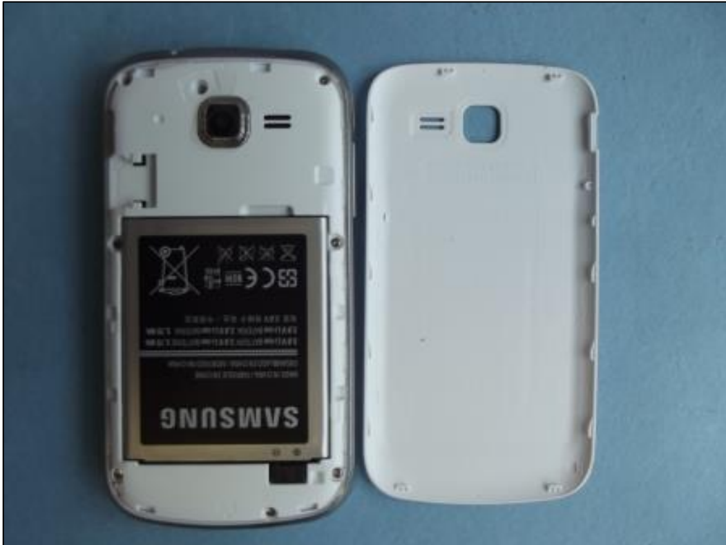
Photo 5: EST – vue arrière (ouvert) avec batterie
